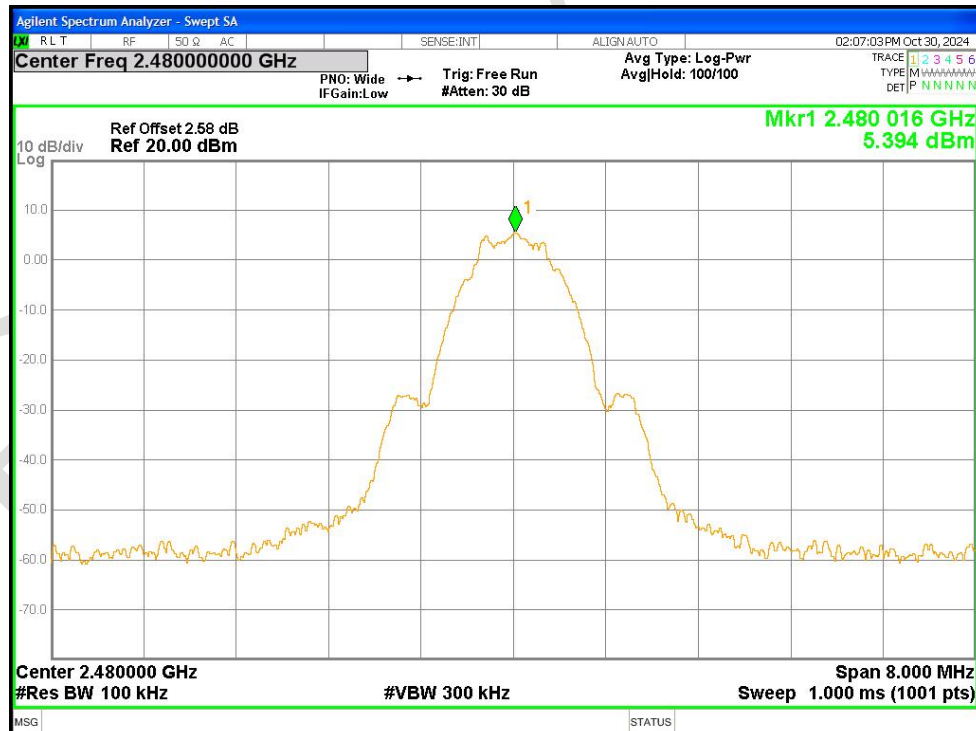
Band Edge NVNT BLE 2480MHz Ant1 Emission
