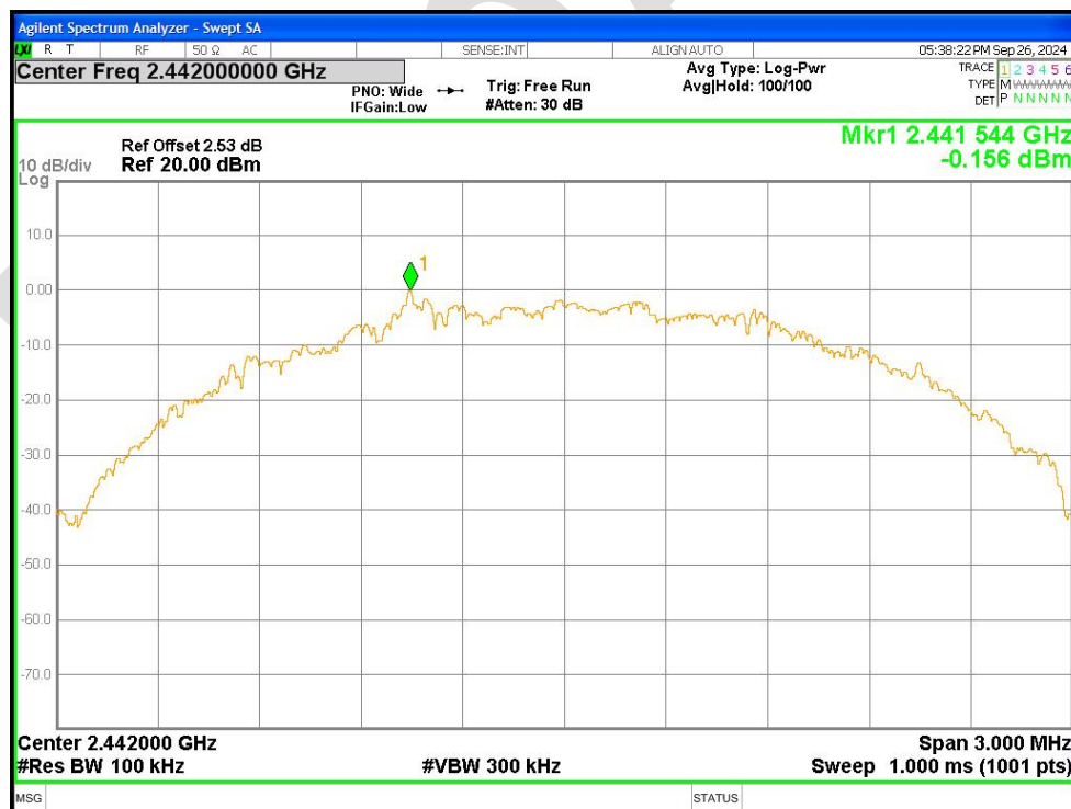
Tx. Spurious NVNT BLE 2M 2442MHz Ant1 Emission
