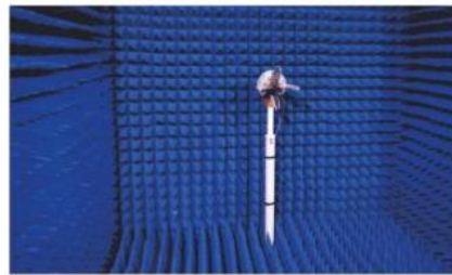
OTA-800 品牌: ETS ✓ 频率范围: 370MHz-8.5GHz 功能: 无源、有源测试; G网、C网、2G/3G/4G, WIFI, BT等制式TRP、TIS测试。
