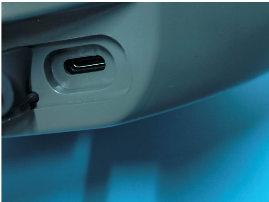
Type-C Interface (Debug Port)
