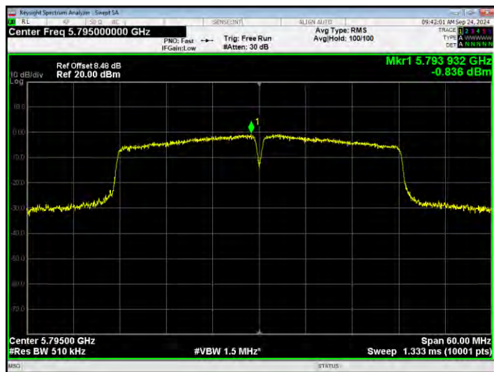
PSD NVNT n40 5795MHz Ant1
