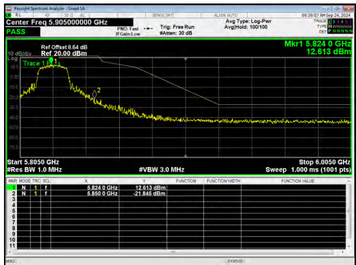
Band Edge NVNT n40 5755MHz Low Ant1
