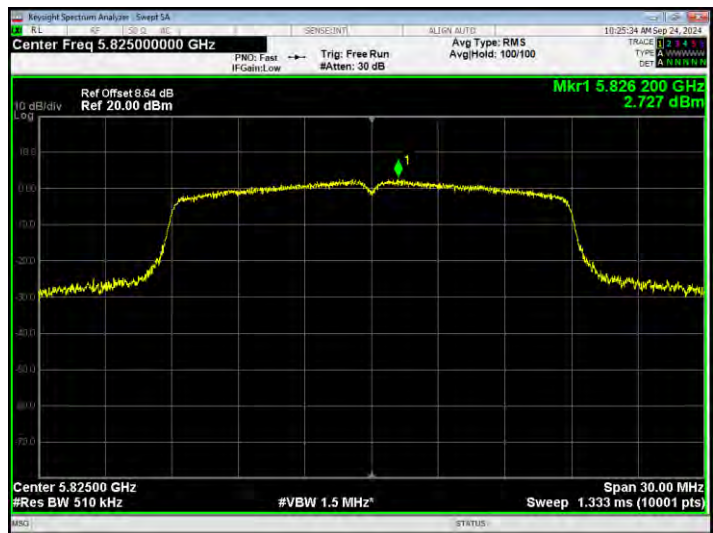
PSD NVNT n40 5755MHz Ant2
