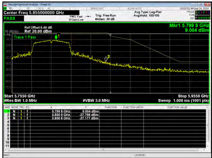
Band Edge NVNT ax20 5745MHz Low Ant1
