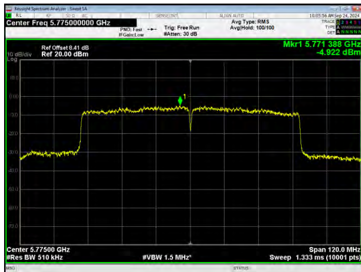
PSD NVNT ax20 5745MHz Ant1
