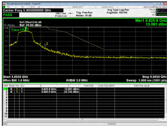
Band Edge NVNT ax40 5755MHz Low Ant1
