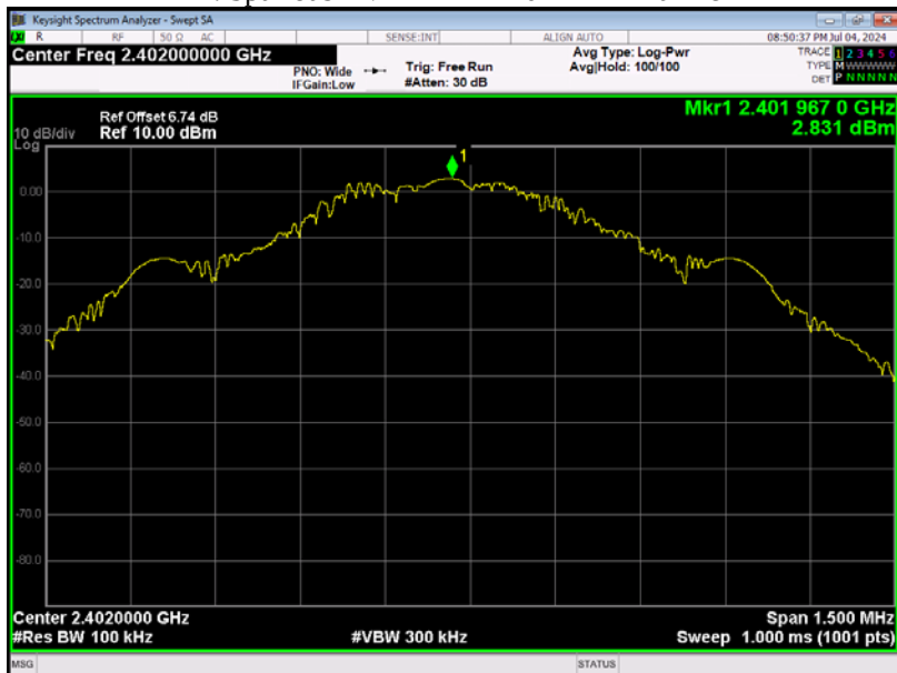
Tx. Spurious NVNT BLE 2402MHz Ant1 Emission
