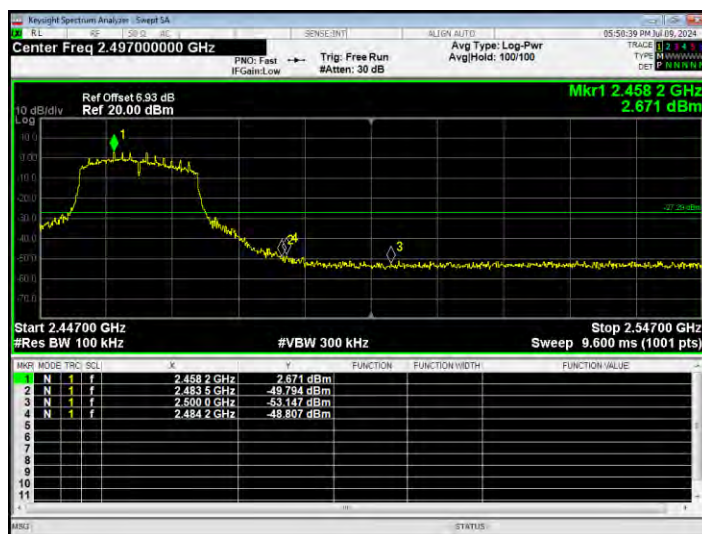
Band Edge NVNT n40 2422MHz Ant1 Ref
