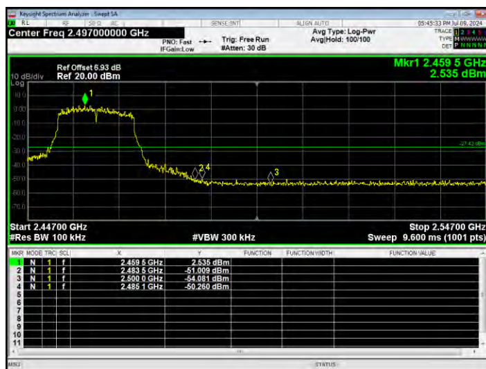
Band Edge NVNT n20 2412MHz Ant1 Ref
