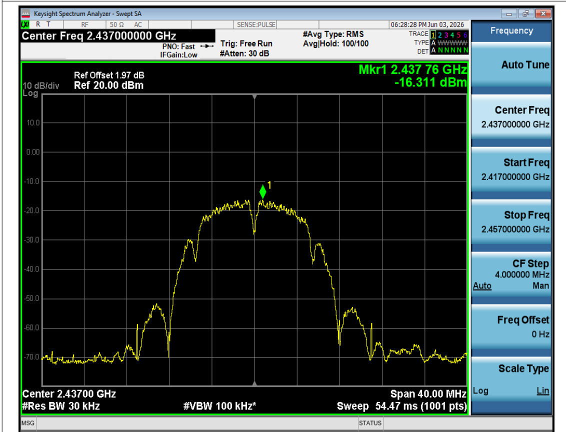
PSD NVNT b 2437MHz Ant1
