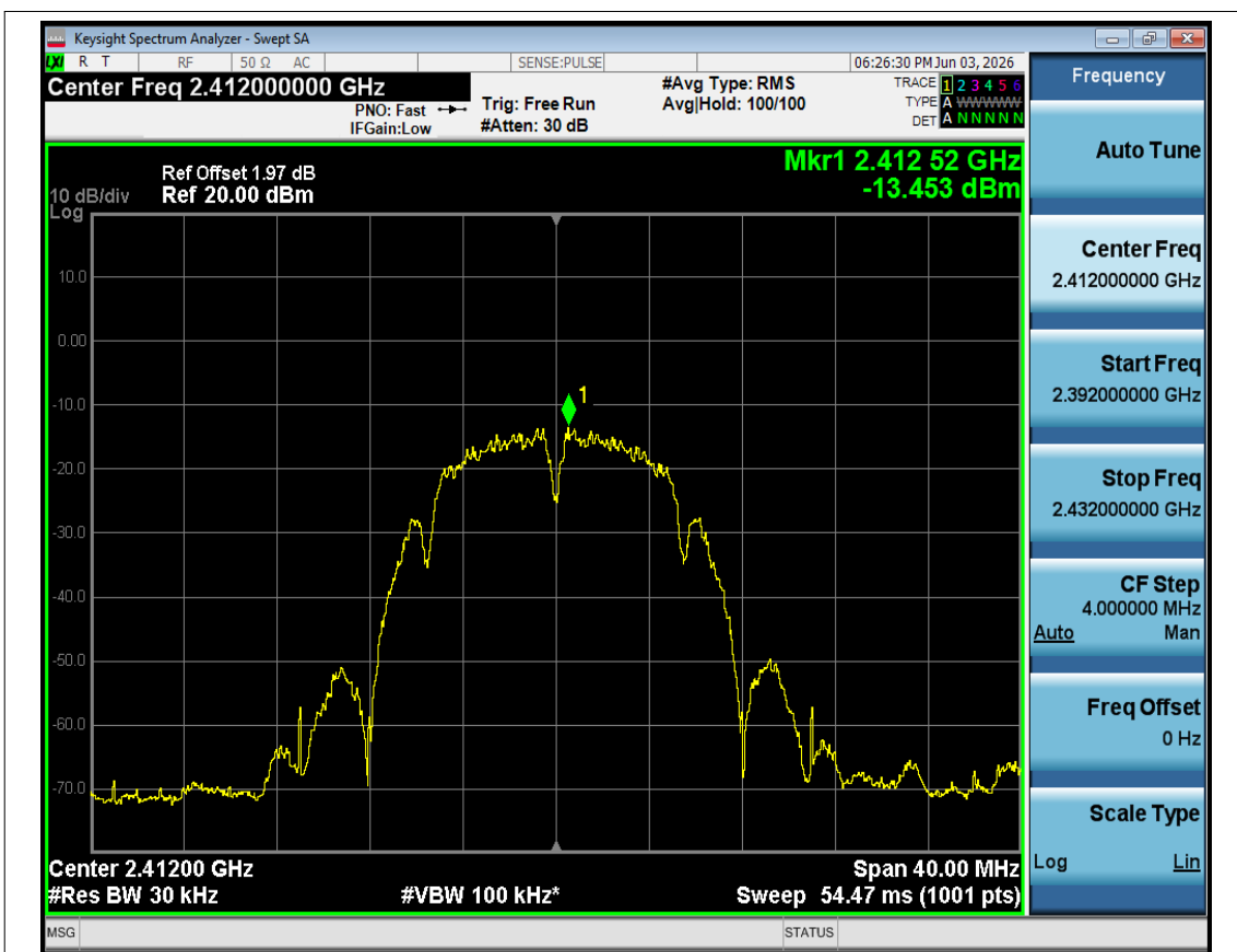
PSD NVNT b 2412MHz Ant1
