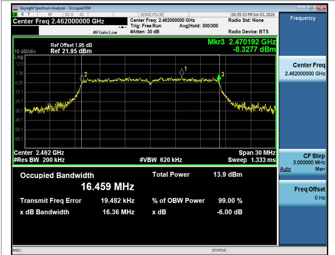
-6dB Bandwidth NVNT g 2462MHz Ant1
