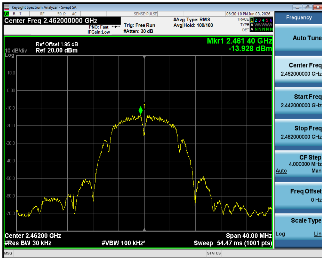
PSD NVNT b 2462MHz Ant1
