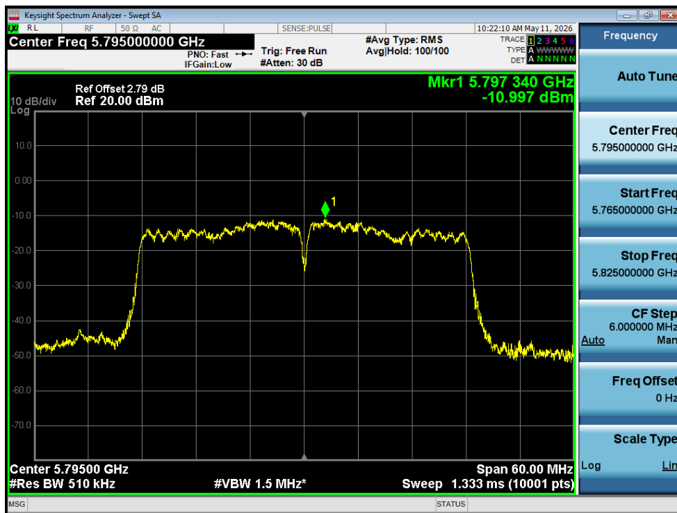
PSD NVNT n40 5795MHz Ant1
