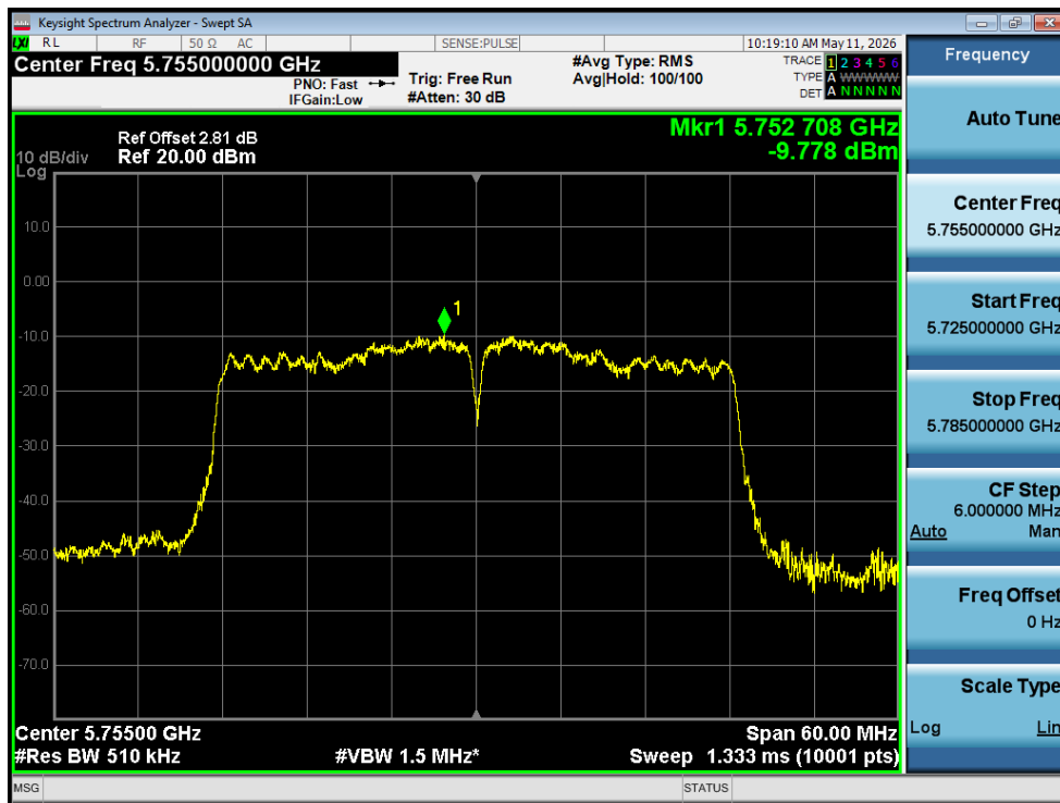
PSD NVNT n40 5755MHz Ant1
