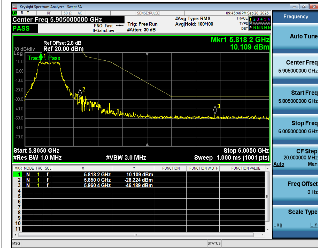
Band Edge NVNT ac20 5825MHz High Ant1
