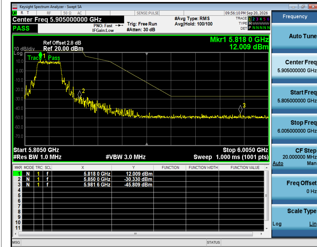
Band Edge NVNT ax20 5825MHz High Ant1
