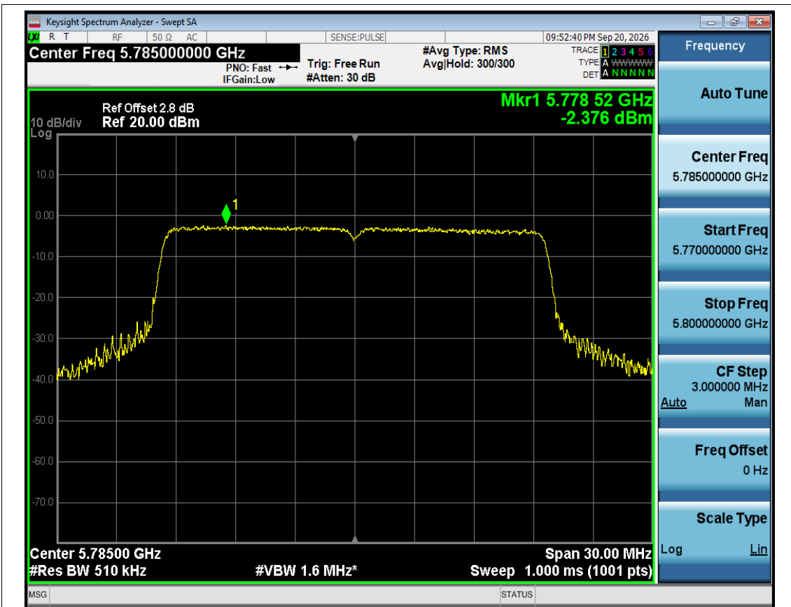
PSD NVNT ax20 5785MHz Ant1
