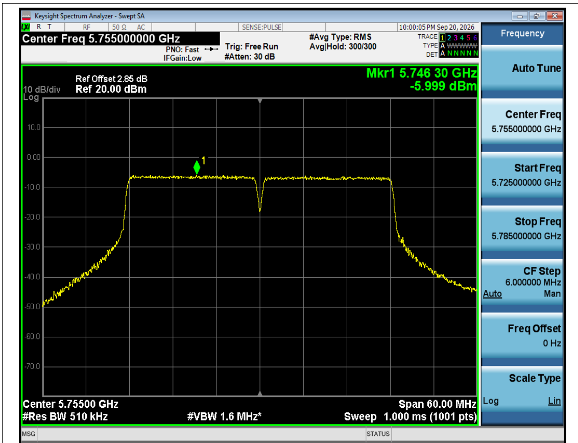
PSD NVNT n40 5755MHz Ant1
