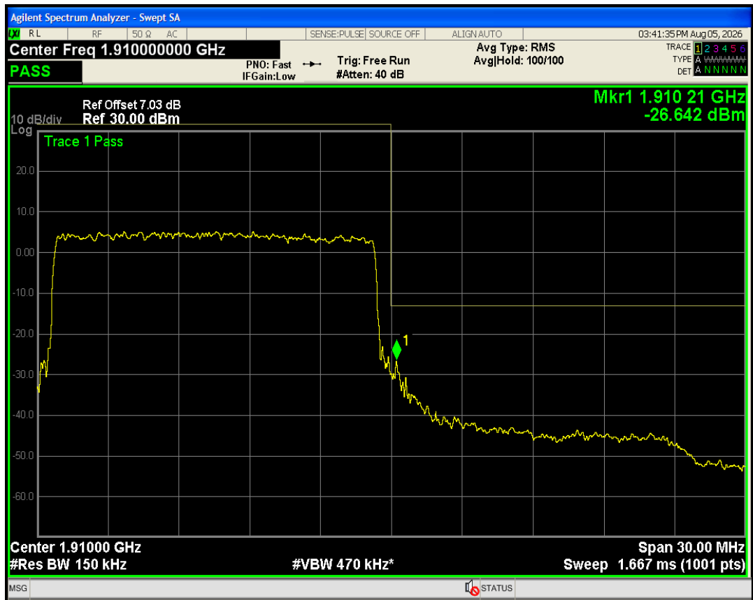
Band2 QPSK BW=20MHz Channel=18700 RB Size=100 Position=#0
