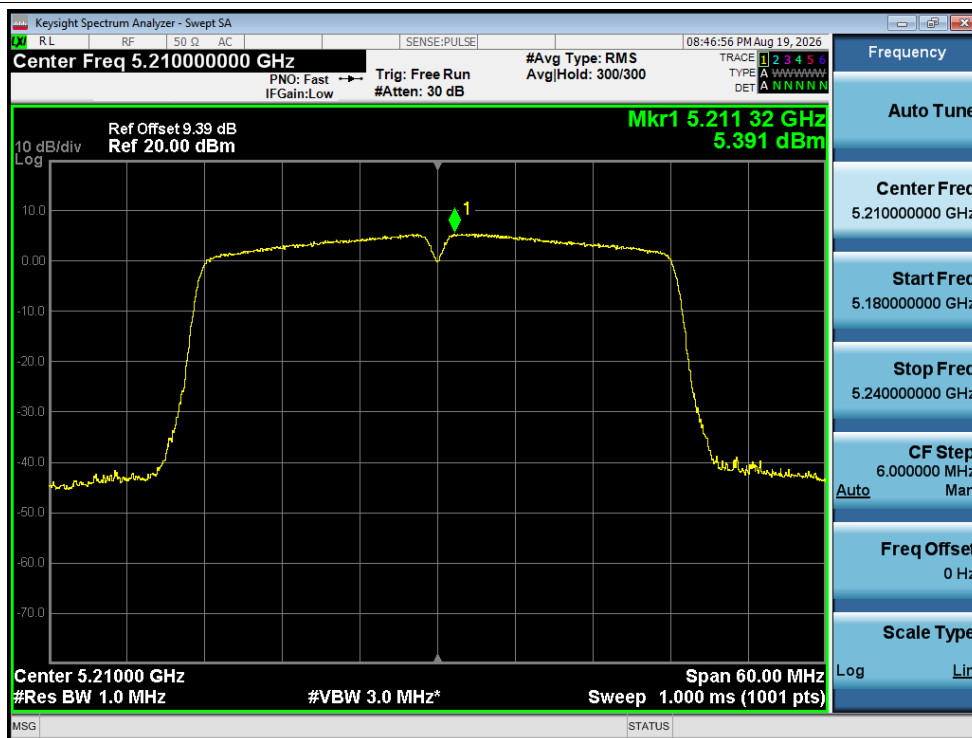
PSD NVNT 40M 5210MHz Ant1
