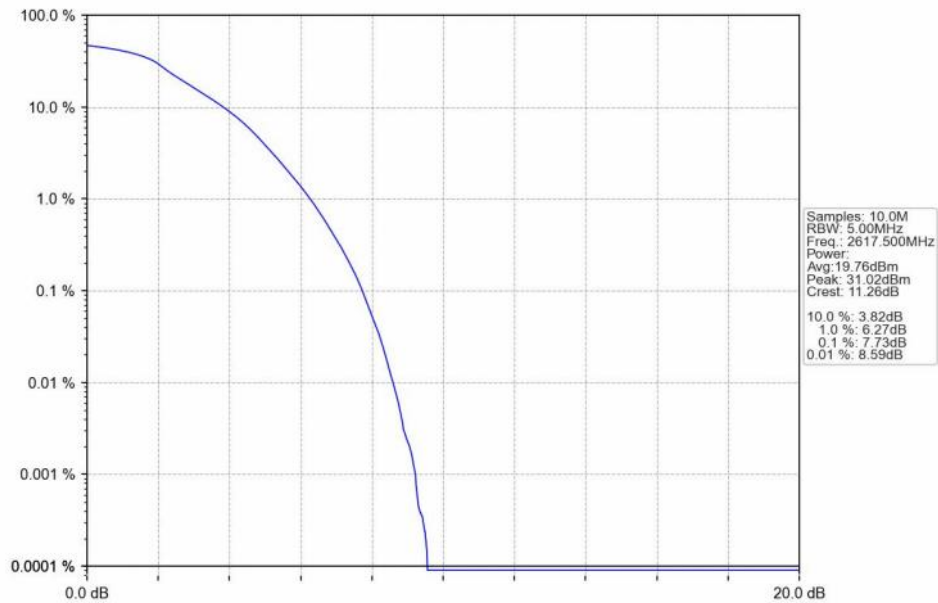
Band38 5MHz QPSK HCH 2617.5MHz RB 25 0 NTNV
