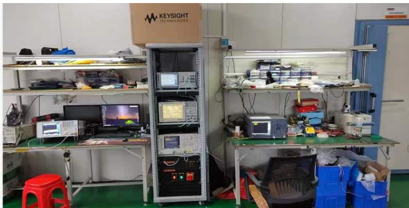
图 6 测试环境：OTA743 暗室，8960/W500/8753ES/5071C，机器背向放置离标准喇叭天线 4 米转台处
