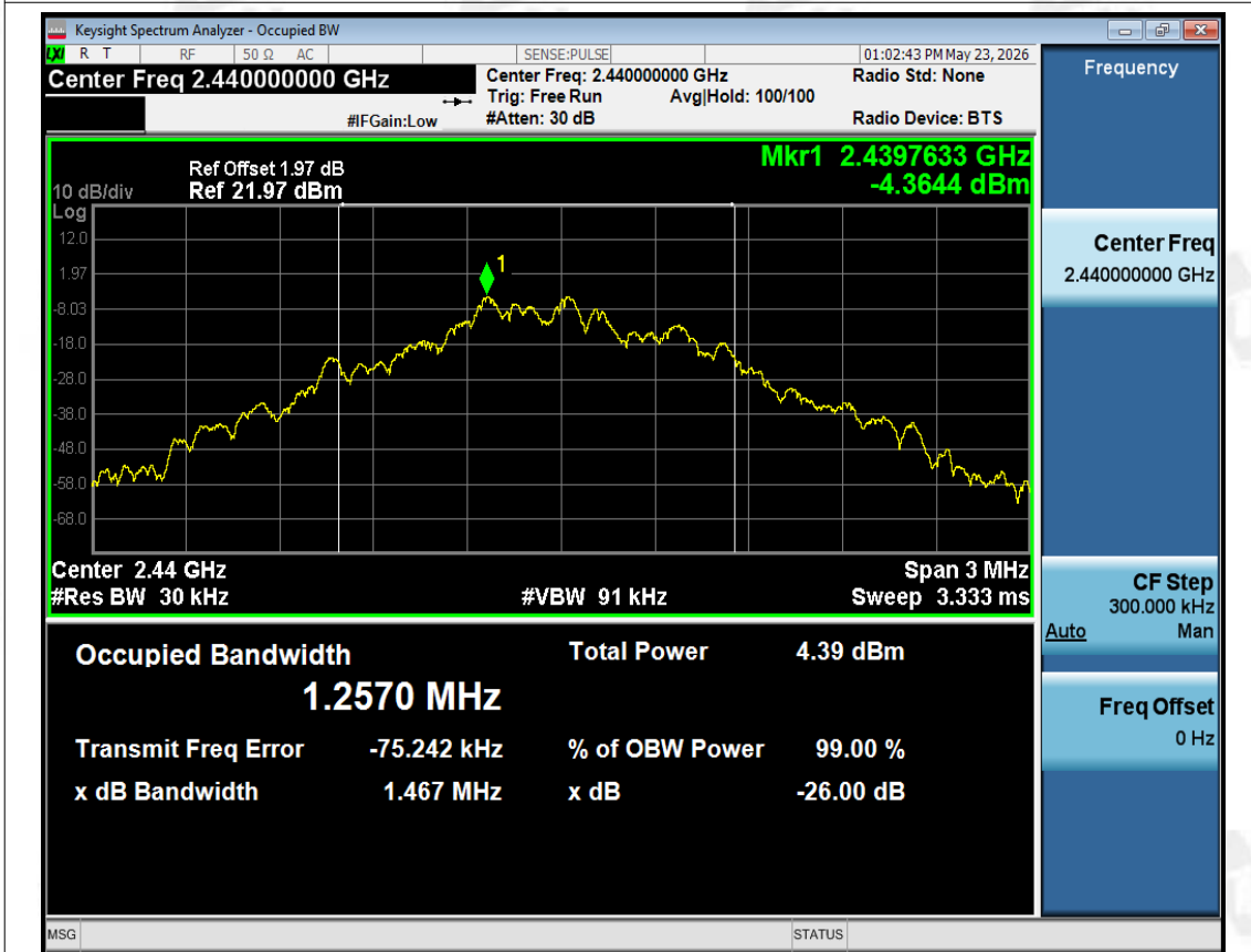
OBW NVNT BLE 1M 2440MHz Ant1
