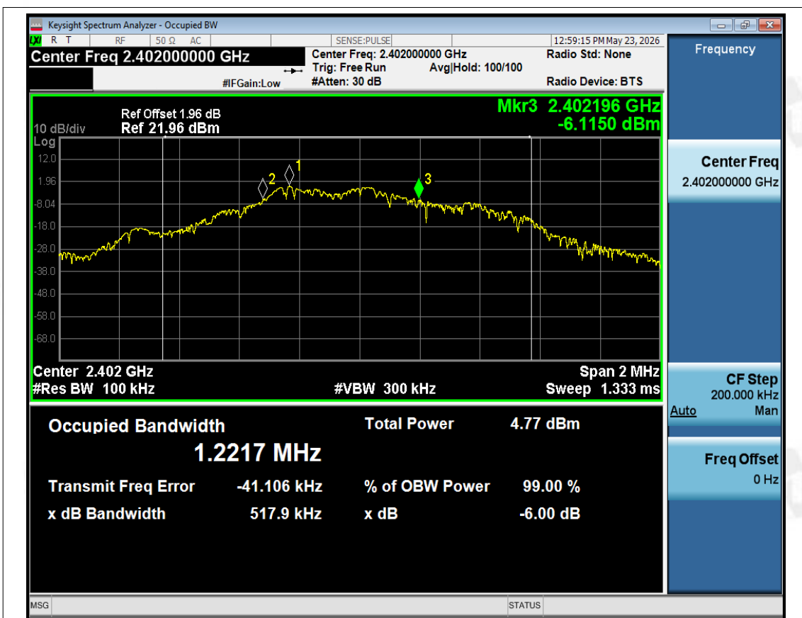
-6dB Bandwidth NVNT BLE 1M 2402MHz Ant1
