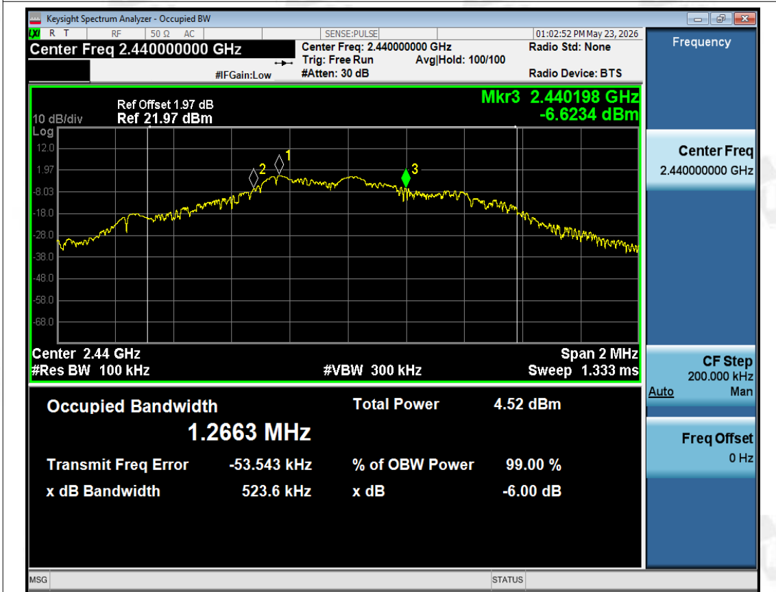
-6dB Bandwidth NVNT BLE 1M 2440MHz Ant1
