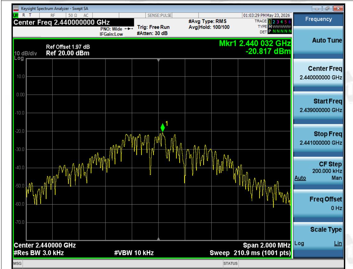
PSD NVNT BLE 1M 2440MHz Ant1
