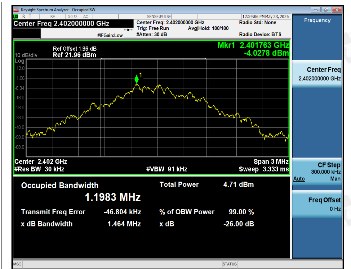
OBW NVNT BLE 1M 2402MHz Ant1
