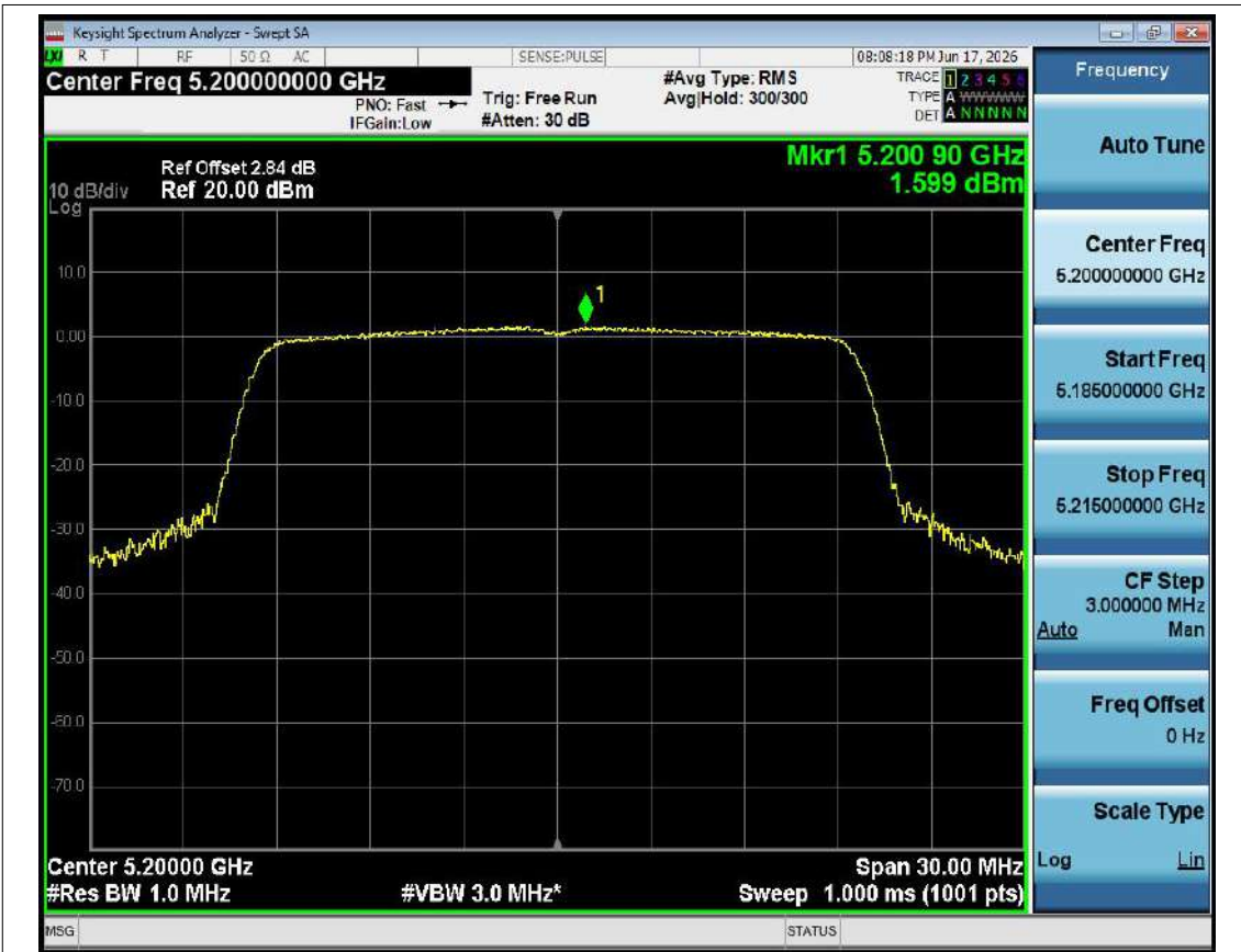
PSD NVNT ax20 5200MHz Ant1
