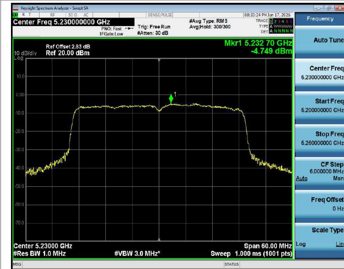
PSD NVNT ax40 5230MHz Ant1
