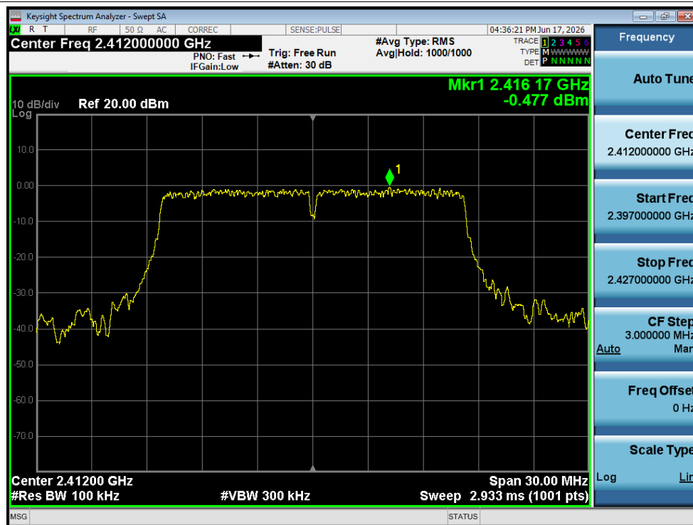
Band Edge NVNT g 2412MHz Ant1 Ref
