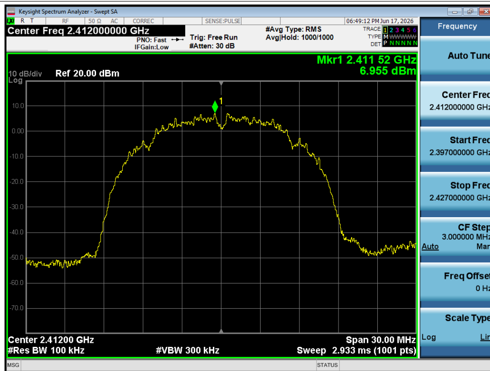
Band Edge NVNT b 2412MHz Ant1 Ref
