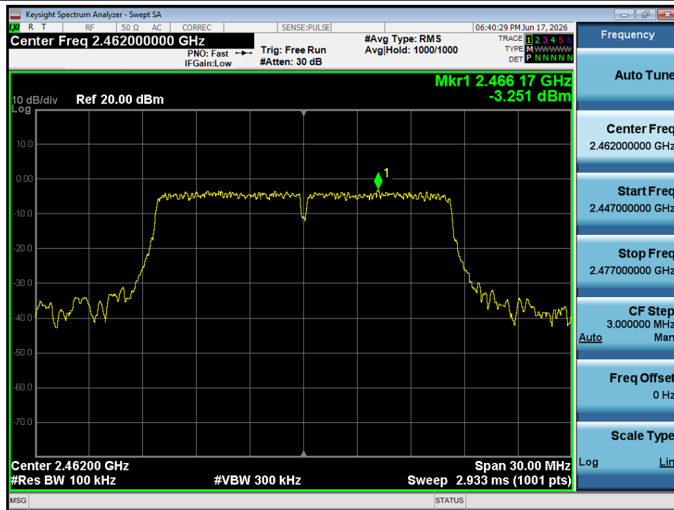
Band Edge NVNT g 2462MHz Ant1 Ref
