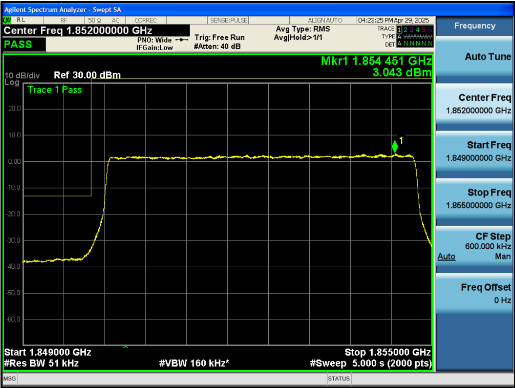
Test_Graph_band2_1852.5MHz_5M_16QAM_25RB#LOW_Band edge
