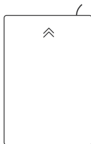
矢印の方向にスライドして電池ボックスを開きます
