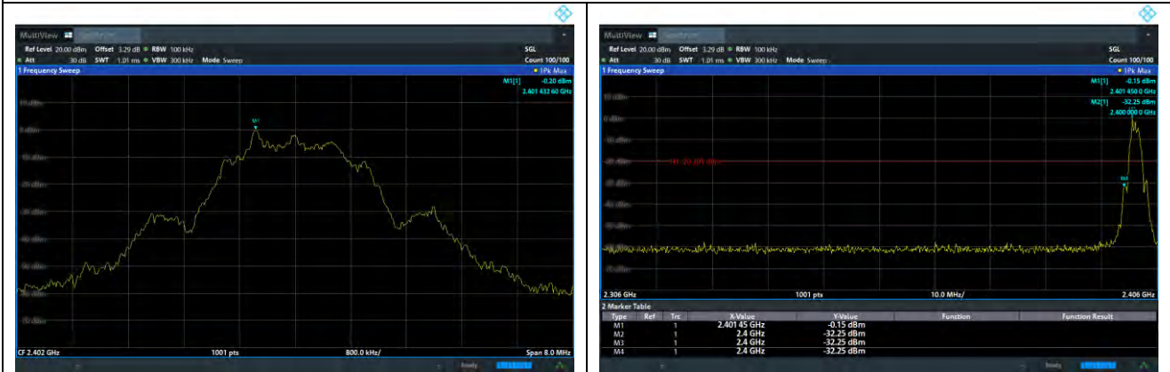
BLE 2M: Band Edge, Right Side
