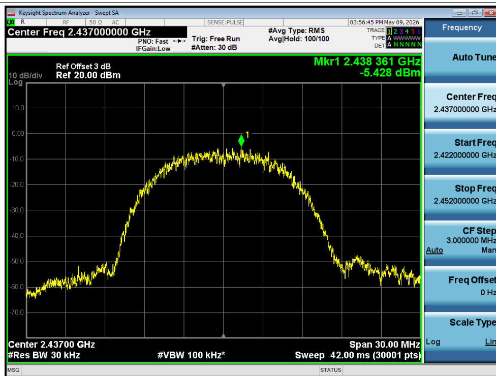
PSD NVNT b 2437MHz Ant1
