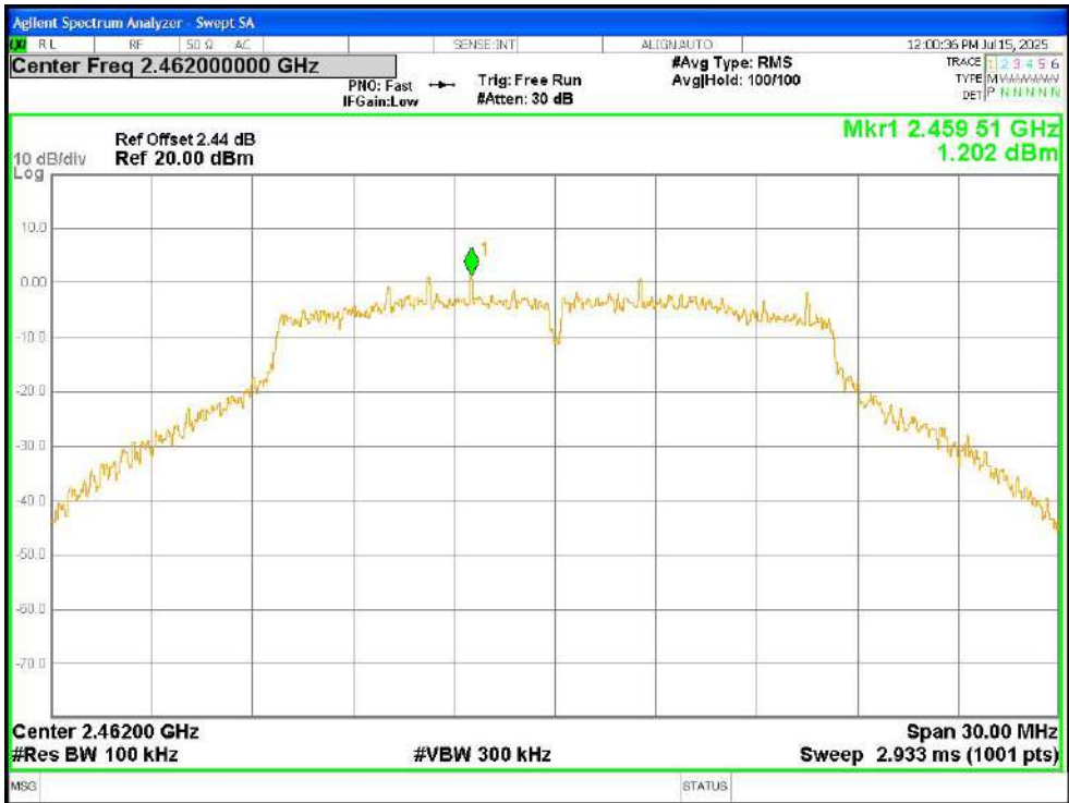
Band Edge NVNT g 2462MHz Ant2 Ref
