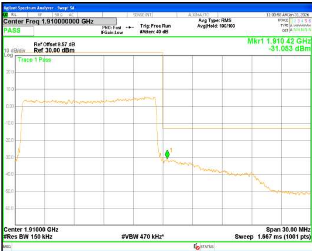
Band2 16QAM BW=20MHz Channel=18700 RB Size=100 Position=#0
