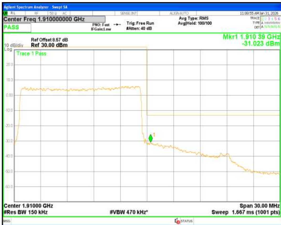
Band2 QPSK BW=20MHz Channel=18700 RB Size=100 Position=#0
