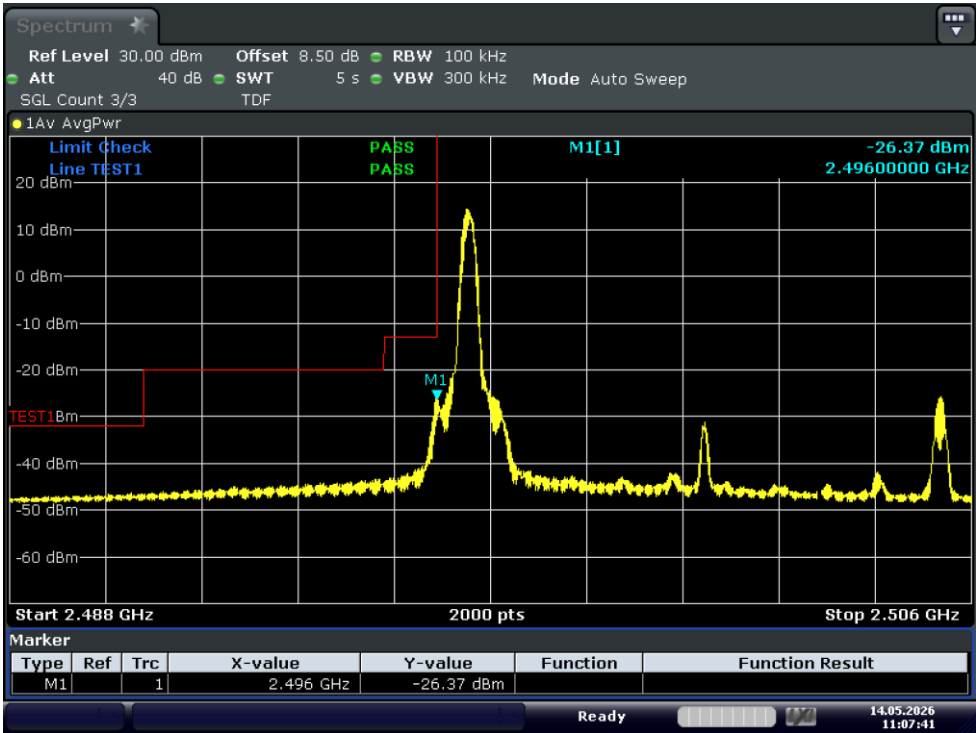
Test_Graph_band41_2501MHz_10M_16QAM_1RB#LOW_Band edge
