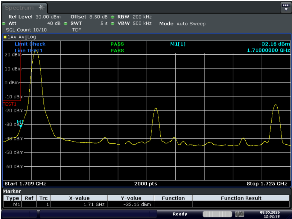
Test_Graph_band66_1717.5MHz_15M_16QAM_1RB#LOW_Band edge
