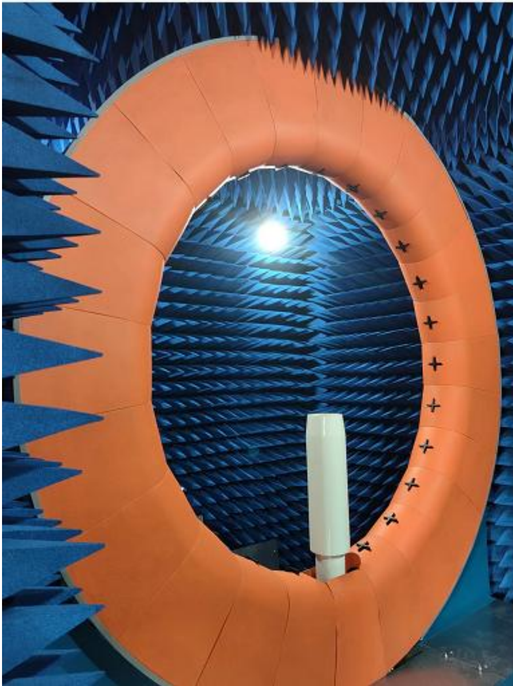
24 探头微波暗室测试设备
