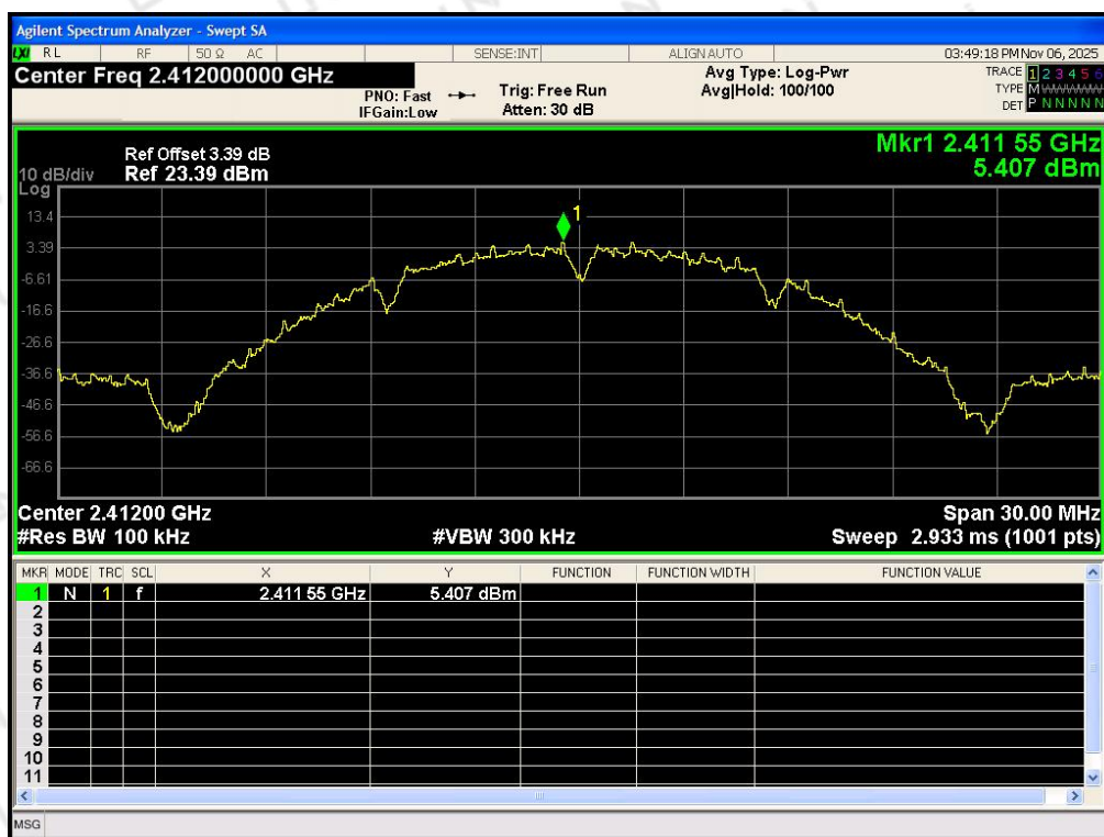
Band Edge NVNT 802.11b 2412MHz Ant1 Ref
