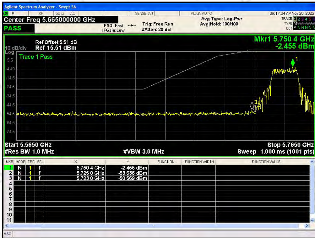
Band Edge NVNT 802.11a 5745MHz Ant1
