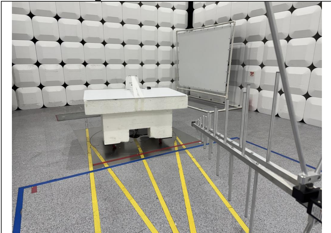
Test distance : 3 m, height of table : 0.8 m
