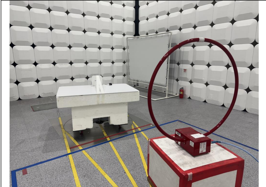
Test distance : 3 m, height of table : 0.8 m
