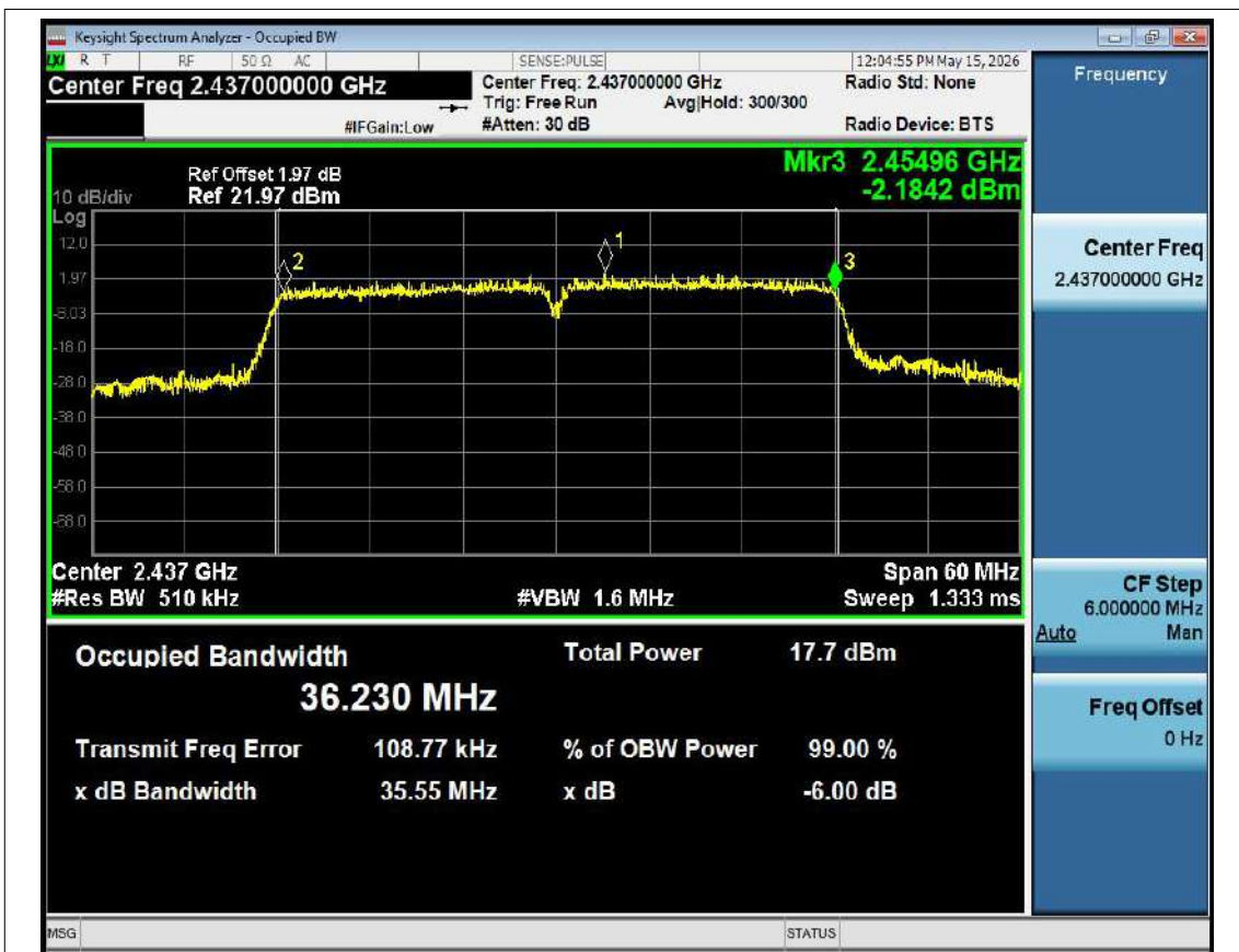
-6dB Bandwidth NVNT n40 2437MHz Ant1
