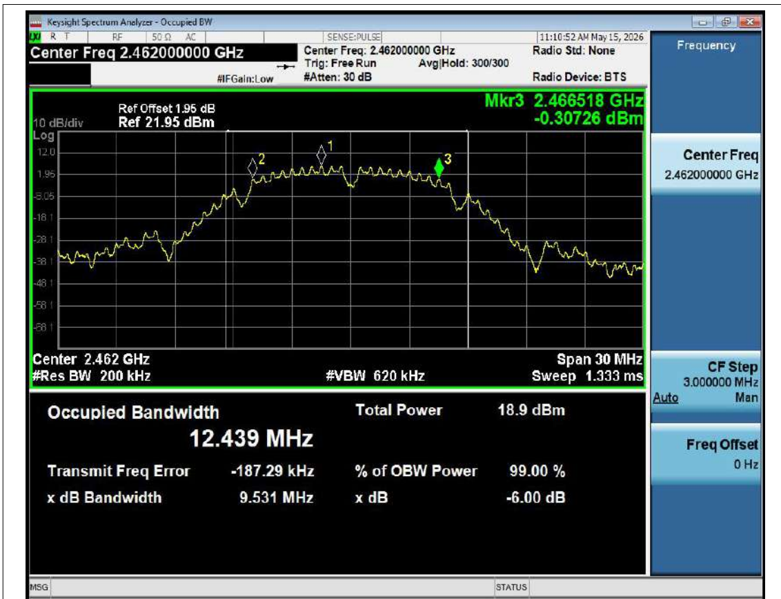
-6dB Bandwidth NVNT b 2462MHz Ant1
