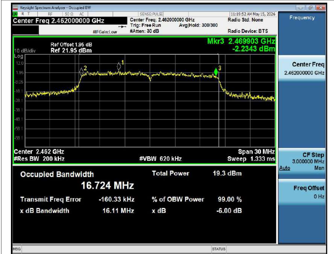
-6dB Bandwidth NVNT g 2462MHz Ant1
