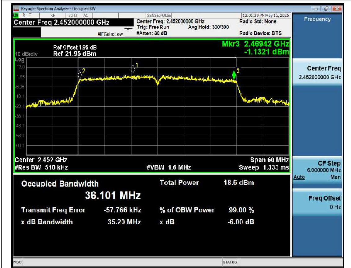
-6dB Bandwidth NVNT n40 2452MHz Ant1
