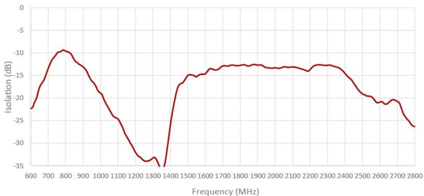
Isolation câble 1 et 2
