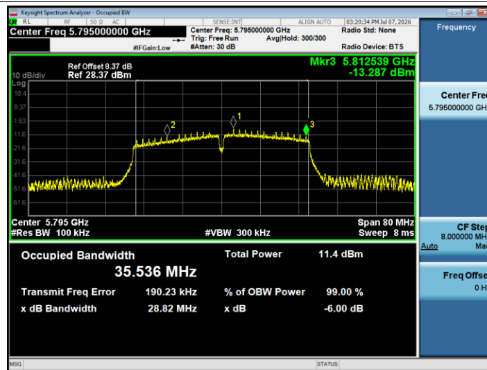
-6dB Bandwidth NVNT n40 5795MHz Ant1
