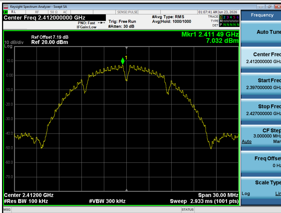
Band Edge NVNT b 2412MHz Ant1 Ref
