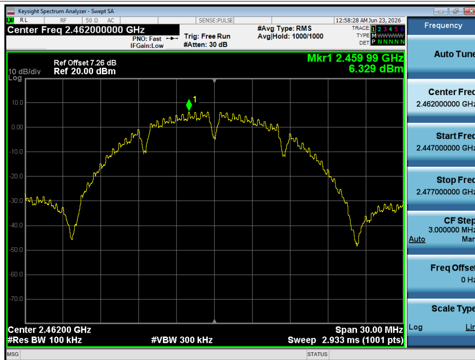
Band Edge NVNT b 2462MHz Ant1 Ref
