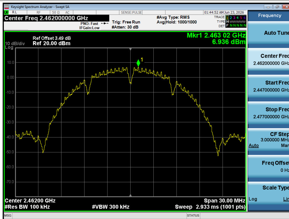
Band Edge NVNT b 2462MHz Ant2 Ref
