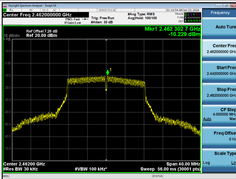
PSD NVNT g 2462MHz Ant1
