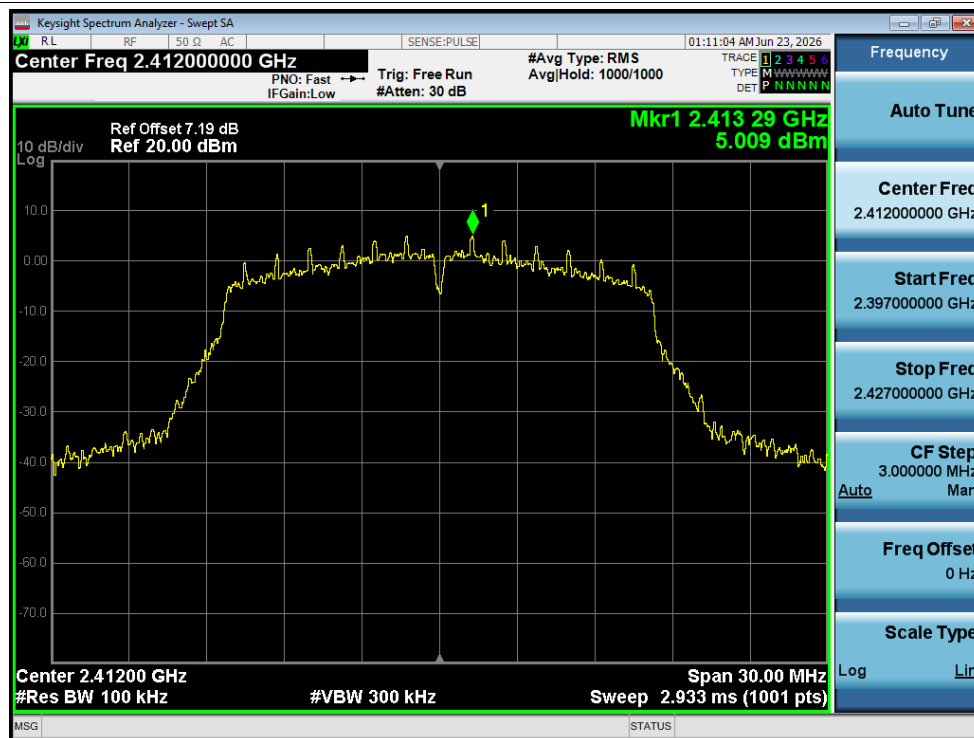
Band Edge NVNT g 2412MHz Ant1 Ref
