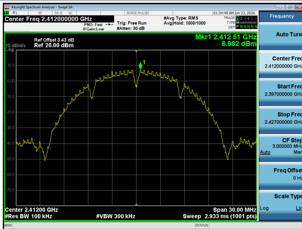
Band Edge NVNT b 2412MHz Ant2 Ref
