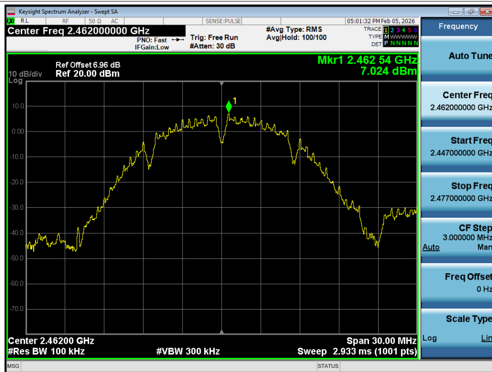
Band Edge NVNT b 2462MHz Ant1 Ref
