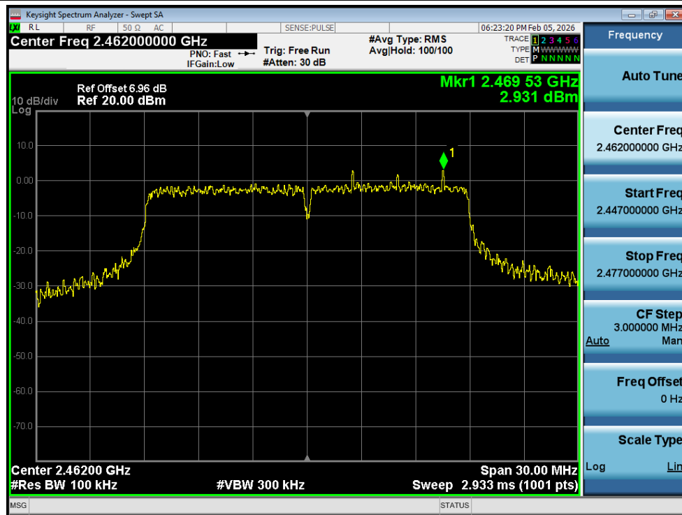
Band Edge NVNT n20 2462MHz Ant1 Ref
