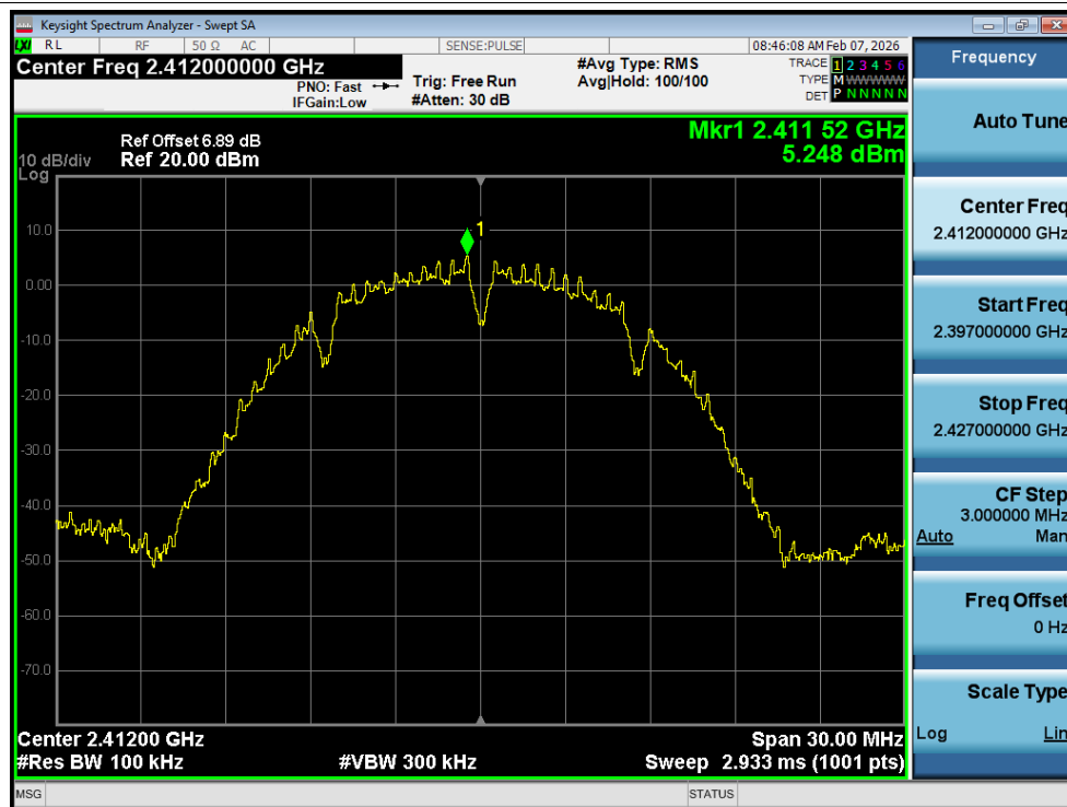
Band Edge NVNT b 2412MHz Ant1 Ref
