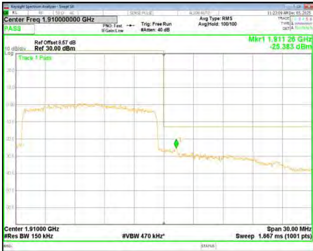
Band2 16QAM BW=20MHz Channel=18700 RB Size=100 Position=#0
