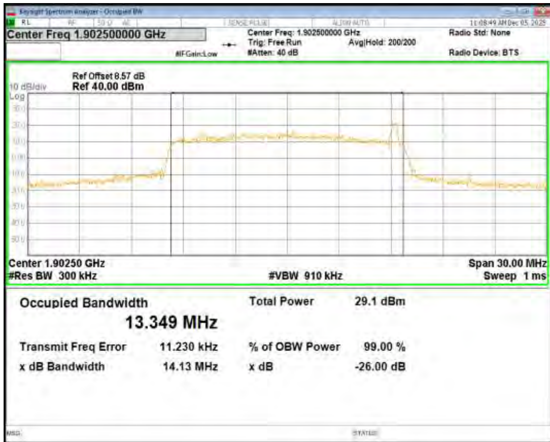
Band2 16QAM BW=20MHz Channel=18700 RB Size=100 Position=#0
