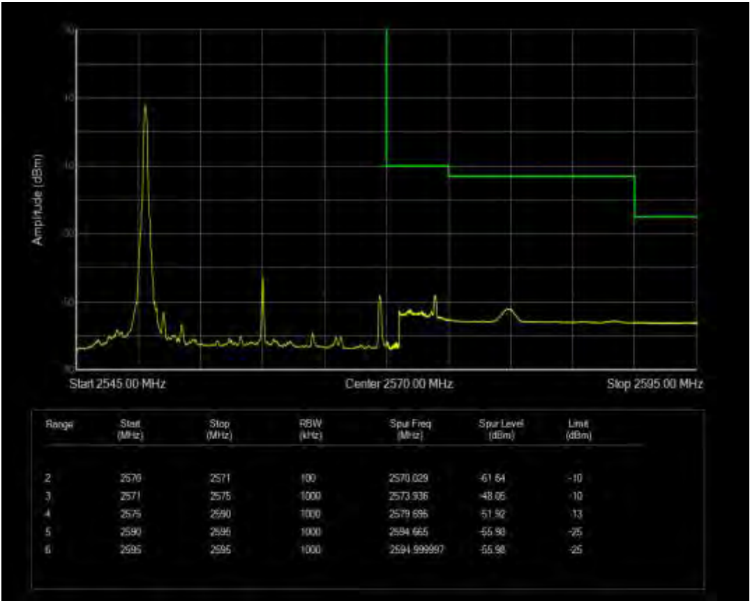
n7 SCS=15kHz CP QPSK BW=20MHz Channel=512000 RB=1@105
