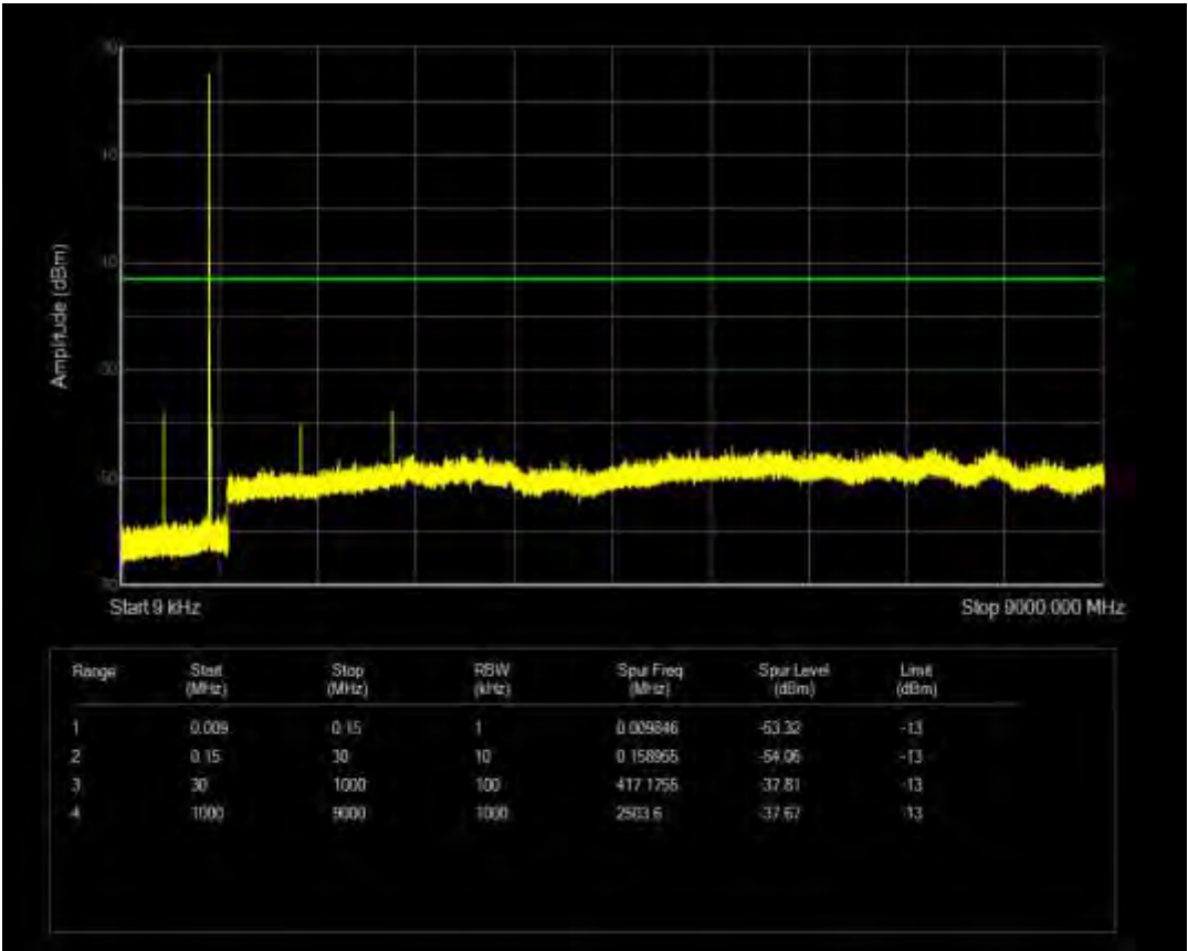
n5 SCS=15kHz CP QPSK BW=5MHz Channel=167300 RB=1@24
