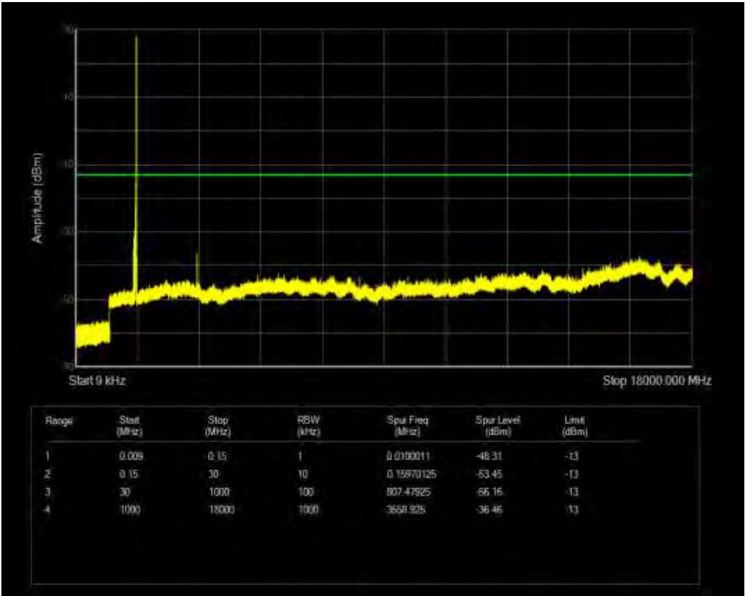
n66 SCS=15kHz CP QPSK BW=40MHz Channel=346000 RB=1@0
