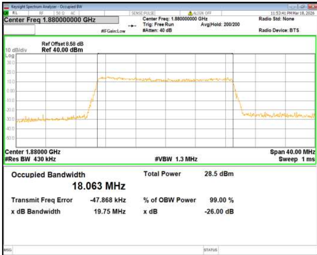
Band2 QPSK BW=20MHz Channel=19100 RB Size=100 Position=#0
