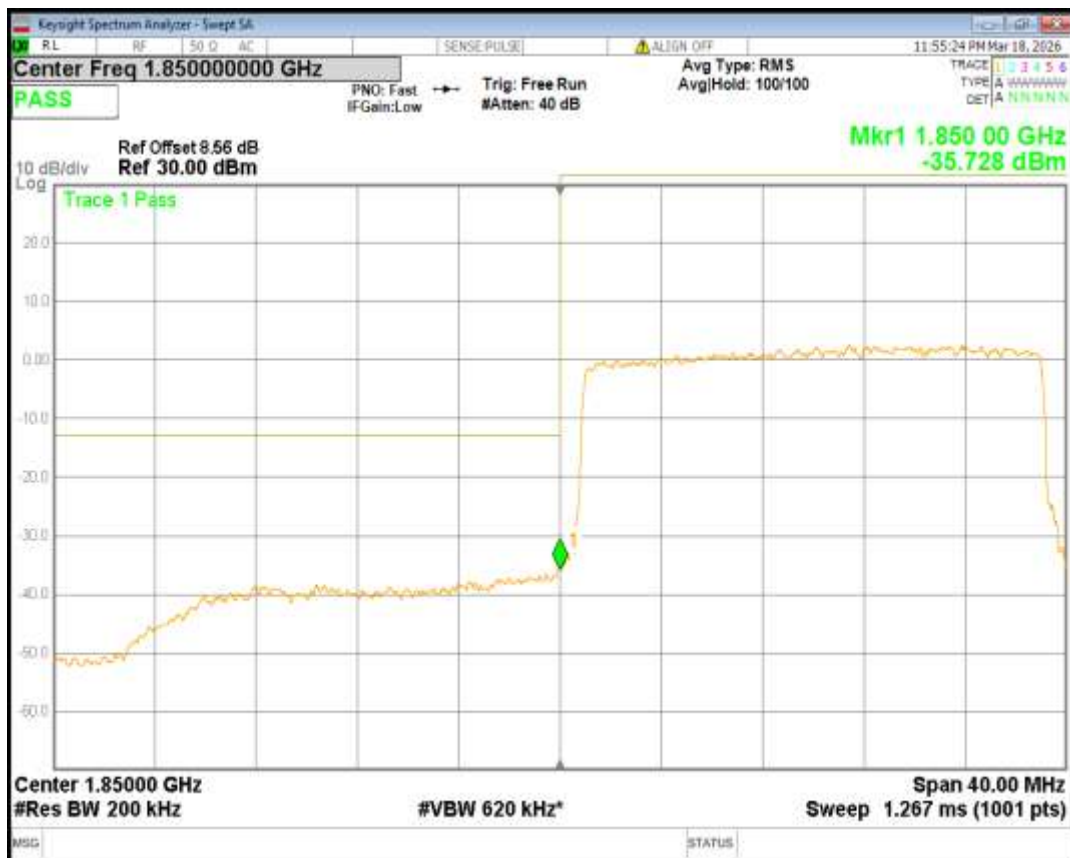
Band2 QPSK BW=20MHz Channel=19100 RB Size=100 Position=#0
