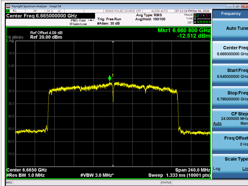
PSD NVNT ax160 6665MHz AntB
