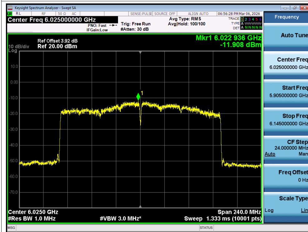
PSD NVNT ax160 6025MHz AntB
