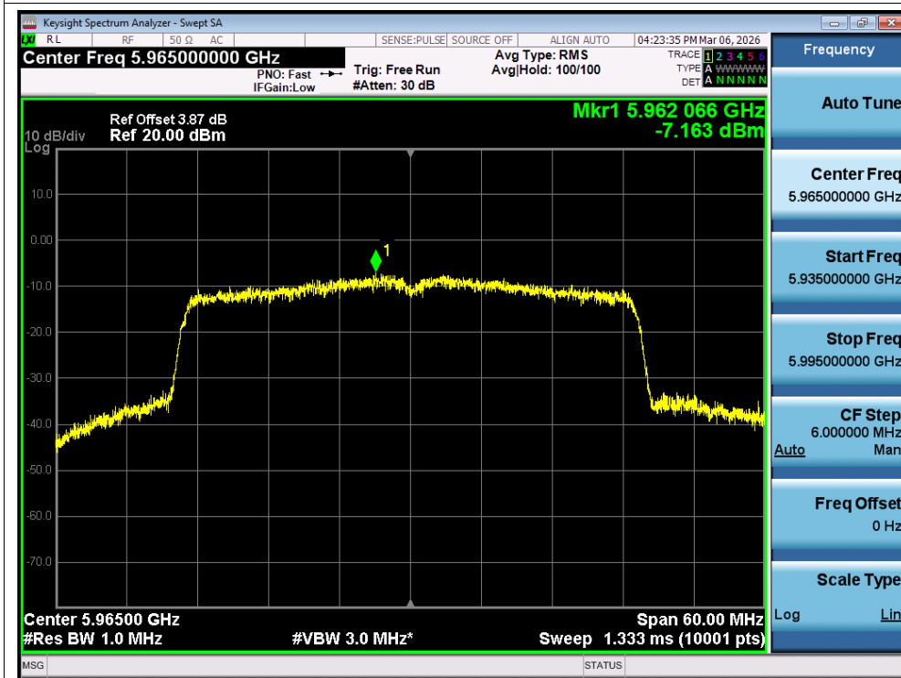
PSD NVNT ax40 5965MHz AntB
