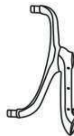
3 ОСНОВНОЙ КРОНШТЕЙН ДЛЯ КРЕПЛЕНИЯ ЛЮЛЬКИ
