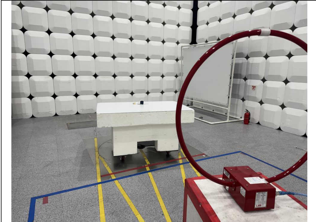
Test distance : 3 m, height of table : 0.8 m
