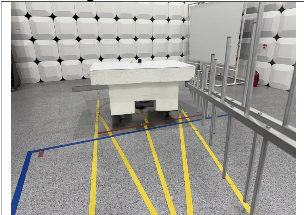
Test distance : 3 m, height of table : 0.8 m
