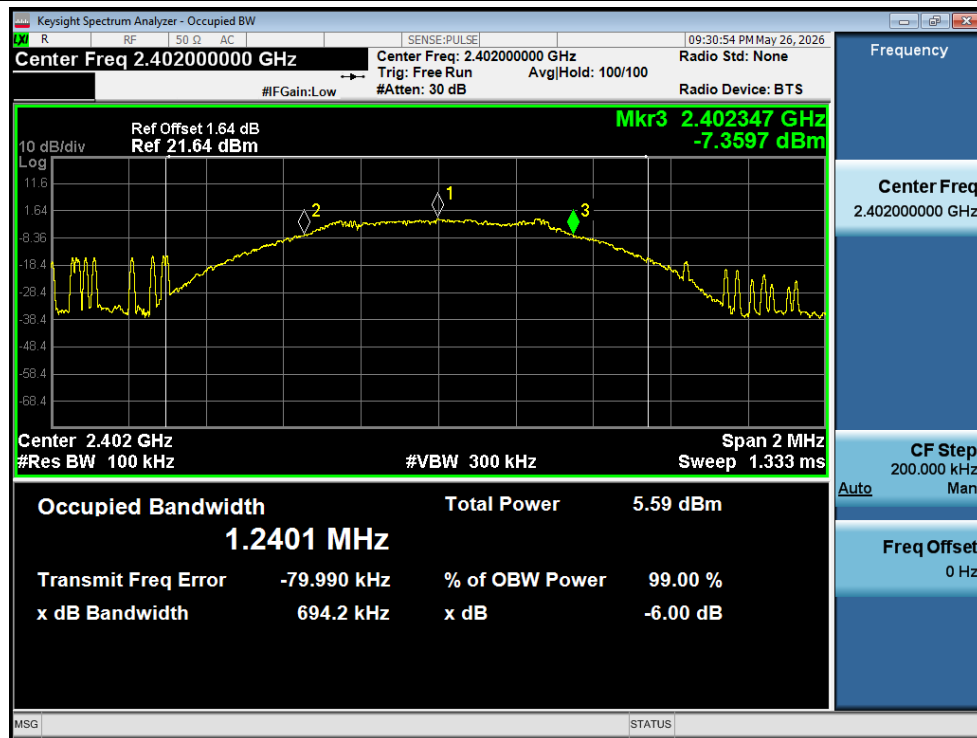
-6dB Bandwidth NVNT BLE 1M 2402MHz Ant1
