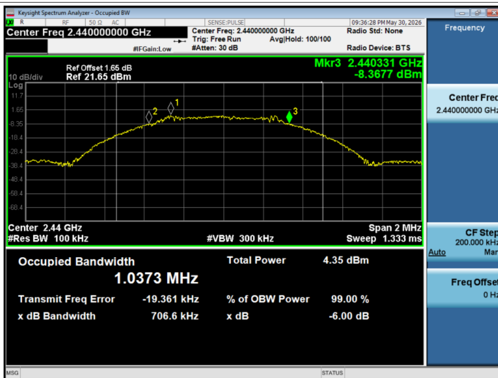
-6dB Bandwidth NVNT BLE 1M 2440MHz Ant1
