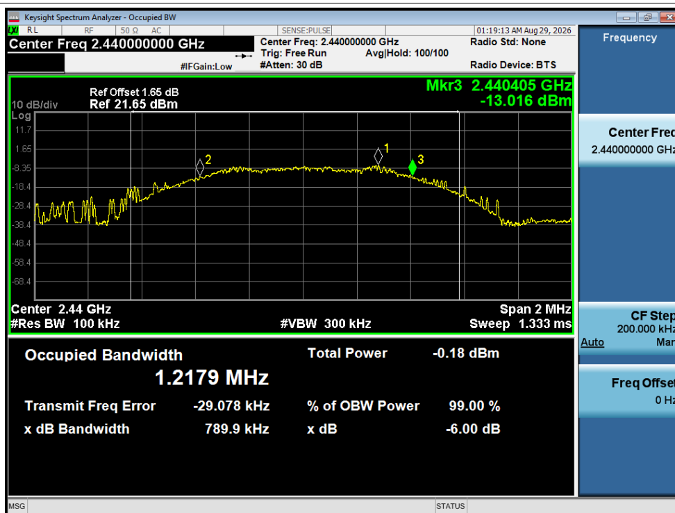
-6dB Bandwidth NVNT BLE 1M 2440MHz Ant1
