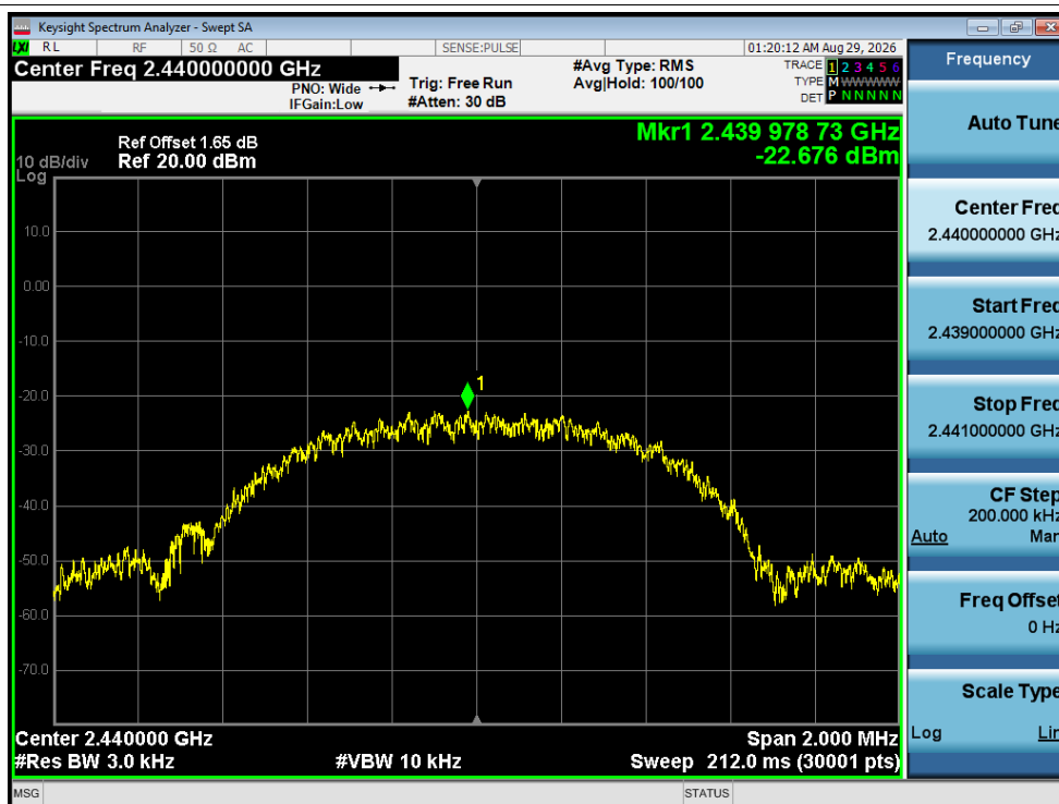
PSD NVNT BLE 1M 2440MHz Ant1
