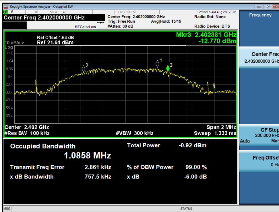
-6dB Bandwidth NVNT BLE 1M 2402MHz Ant1
