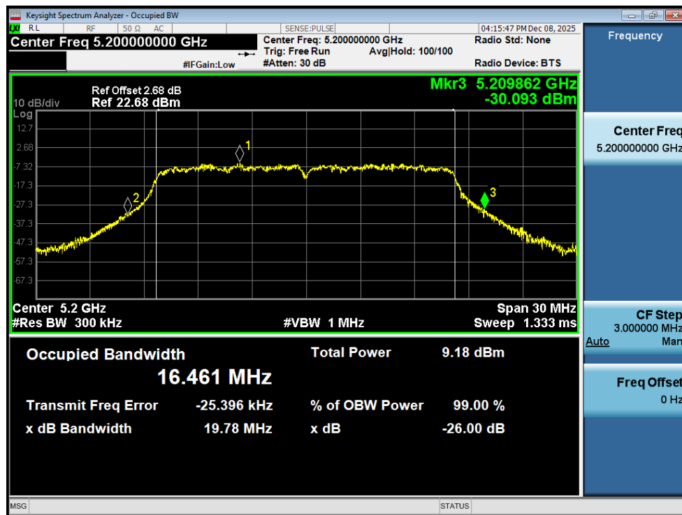
-26dB Bandwidth NVNT a 5200MHz Ant1
