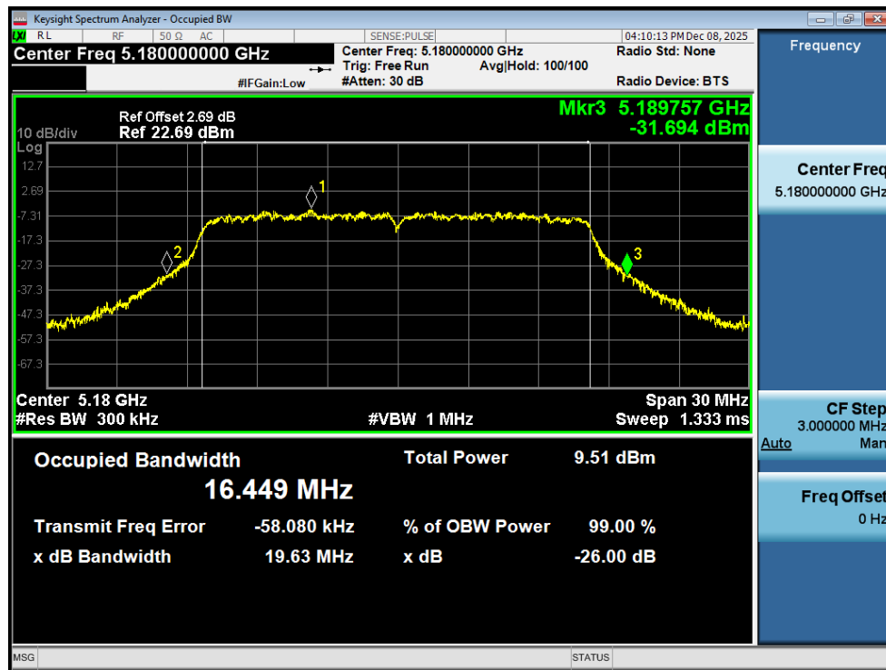
-26dB Bandwidth NVNT a 5180MHz Ant1
