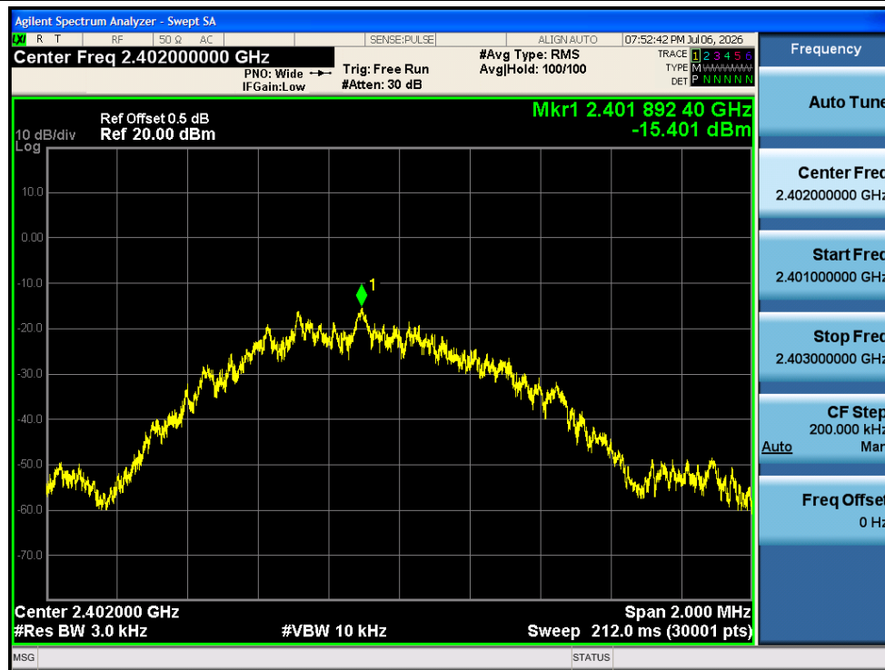
PSD NVNT BLE 1M 2402MHz Ant1
