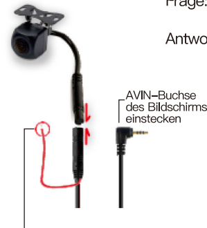
12V-Triggerkabel an den Pluspol des Rücklichts anschließen
