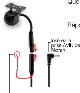
Câble de déclenchement 12V, connectez-le au terminal positif du feu de recul
