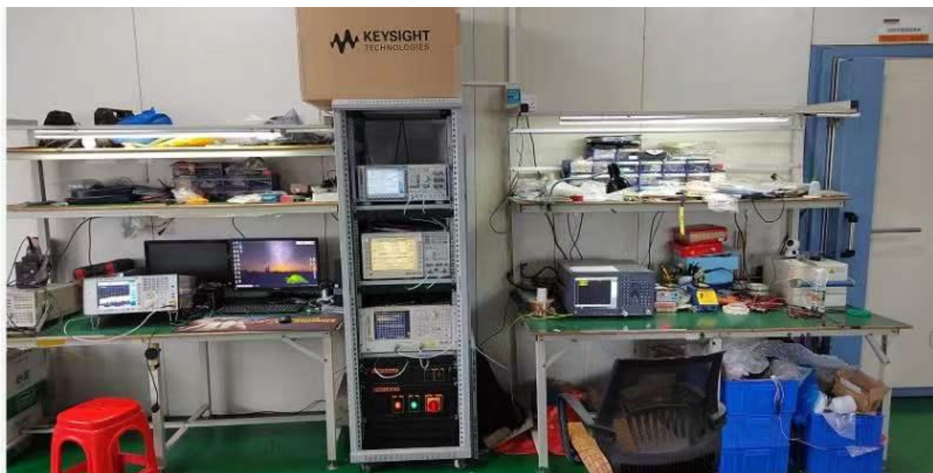
图 6 测试环境：OTA743 暗室，8960/W500/8753ES/5071C，机器背向放置离标准喇叭天线 4 米转台处
