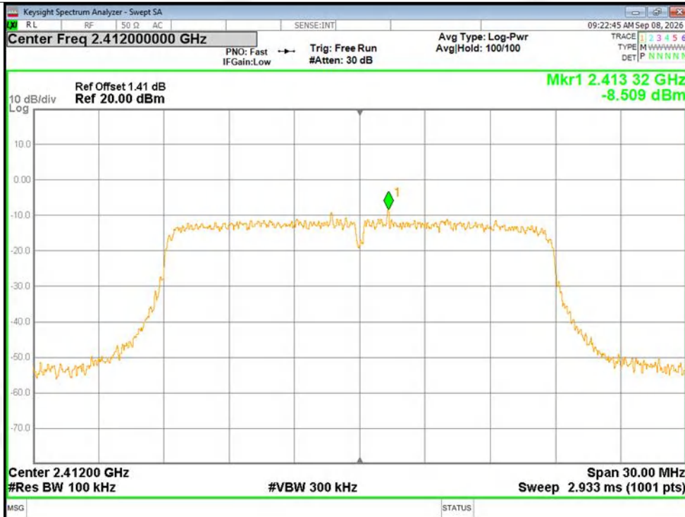
Band Edge NVNT n20 2412MHz Ant1 Ref
