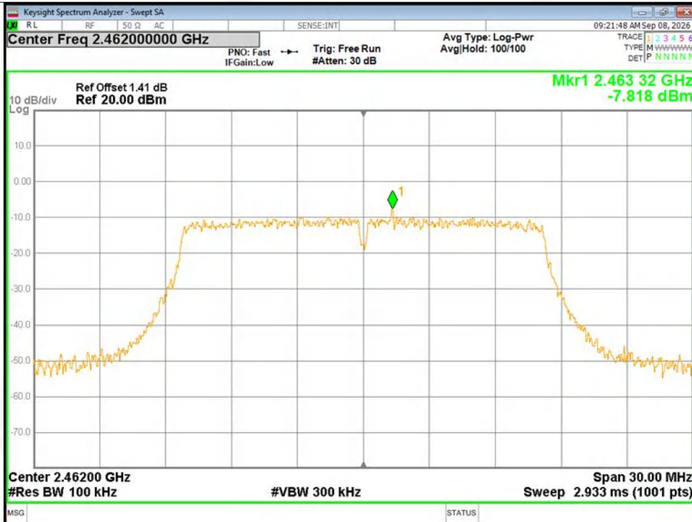
Band Edge NVNT g 2462MHz Ant1 Ref
