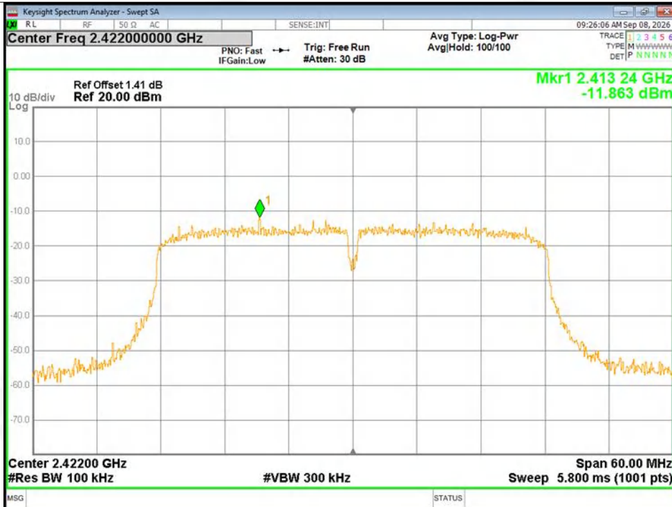
Band Edge NVNT n40 2422MHz Ant1 Ref
