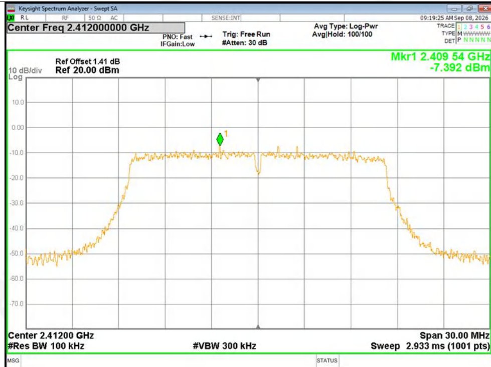
Band Edge NVNT g 2412MHz Ant1 Ref
