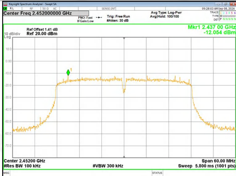
Band Edge NVNT n40 2452MHz Ant1 Ref
