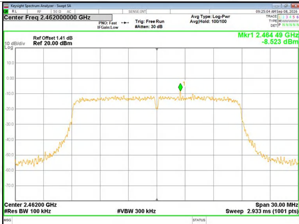
Band Edge NVNT n20 2462MHz Ant1 Ref
