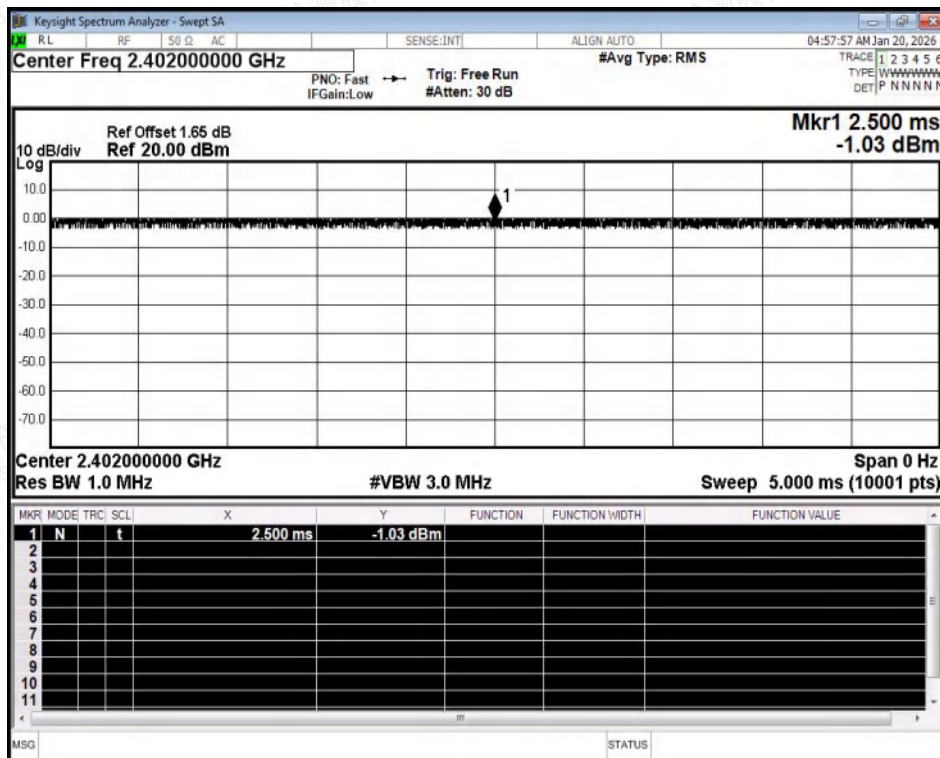
Duty Cycle NVNT BLE 2M 2402MHz Ant1
